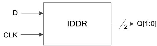
图 3-14 I/O 逻辑的 DDR 输入示意图
