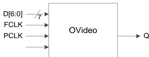
图 3-19 I/O 逻辑的 OVideo 输出示意图
