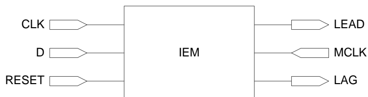
图 3-10 GW1NZ 的 IEM 示意图
