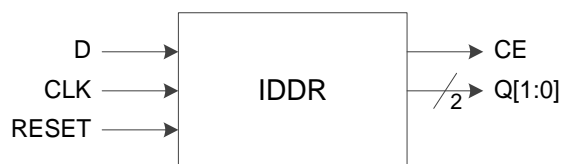
图 3-14 I/O 逻辑的 DDR 输入示意图
