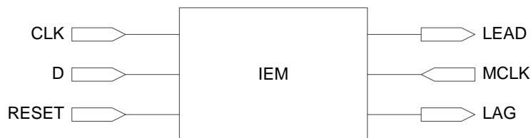
图 3-10 GW1NZ 的 IEM 示意图
