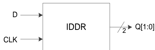
图 3-13 I/O 逻辑的 DDR 输入示意图
