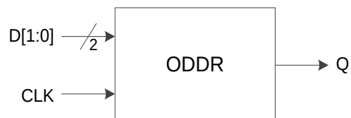
图 3-19 I/O 逻辑的 DDR 输出示意图
