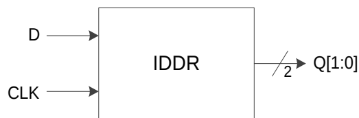
图 3-18 I/O 逻辑的 DDR 输入示意图
