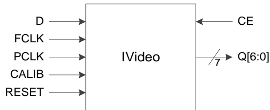
图 3-22 I/O 逻辑的 IVideo 输入示意图
