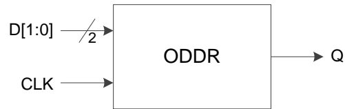
图 3-14 I/O 逻辑的 DDR 输出示意图
