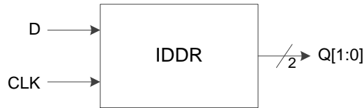
图 3-13 I/O 逻辑的 DDR 输入示意图
