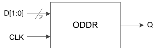
图 3-14 I/O 逻辑的 DDR 输出示意图
