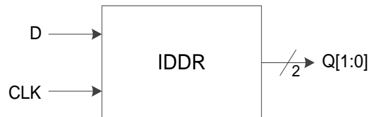
图 3-14 I/O 逻辑的 DDR 输入示意图
