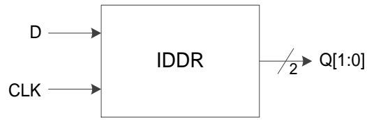
图 3-14 I/O 逻辑的 DDR 输入示意图
