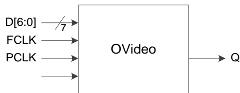
图 3-17 I/O 逻辑的 OVideo 输出示意图
