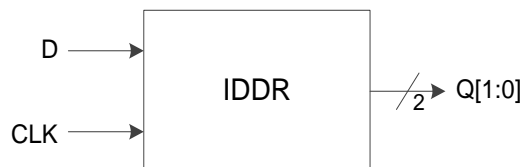
图 3-12 I/O 逻辑的 DDR 输入示意图
