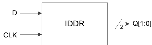
图 3-15 I/O 逻辑的 DDR 输入示意图
