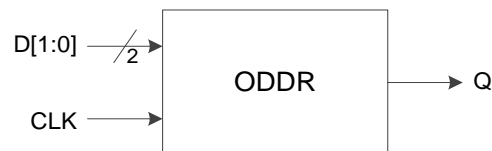
图 3-16 I/O 逻辑的 DDR 输出示意图
