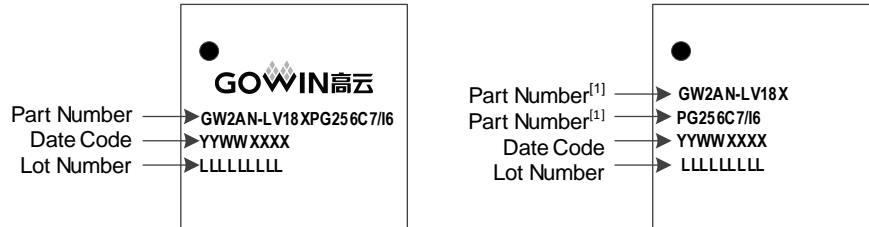
图 5-2 器件封装标识示例
