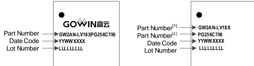
图 5-2 器件封装标识示例
