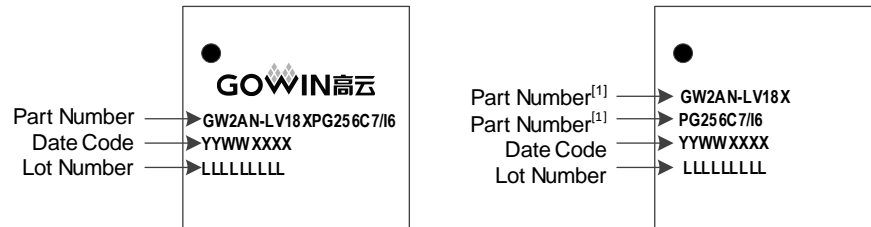
图 5-2 器件封装标识示例
