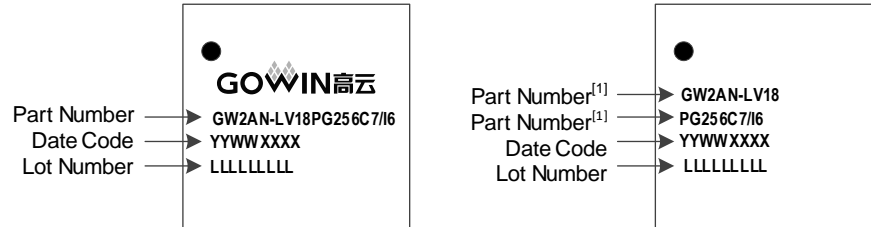
图 5-2 器件封装标识示例
