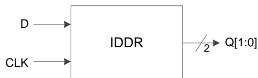
图 3-13 I/O 逻辑的 DDR 输入示意图
