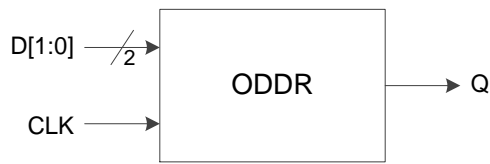
图 3-14 I/O 逻辑的 DDR 输出示意图
