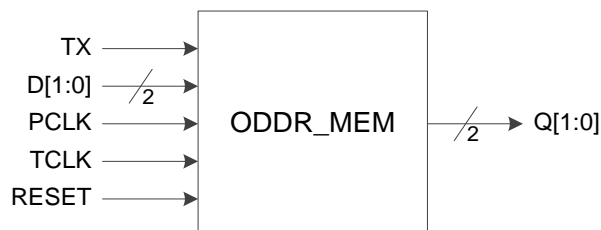
图 3-24 IO 逻辑的 ODDR_MEM 输出示意图
