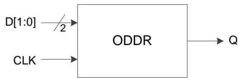
图 3-14 I/O 逻辑的 DDR 输出示意图
