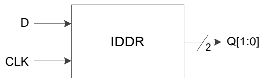
图 3-13 I/O 逻辑的 DDR 输入示意图
