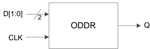
图 3-14 I/O 逻辑的 DDR 输出示意图
