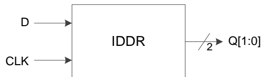
图 3-13 I/O 逻辑的 DDR 输入示意图
