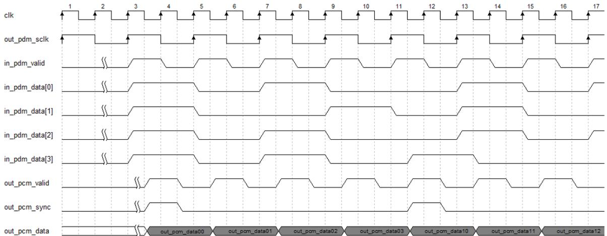
PDM2PCM IP 根据用户需要输出不同频率的 PDM 时钟信号 (`out_pdm_sclk`)。通过获取多组通道的 PDM 输入有效数据 (`in_pdm_data[0-N]`) 进行处理，输出多组通道的有效数据，每组通道以同步信号 (`out_pcm_sync`) 进行区分。
