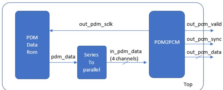
利用该设计实例能够快速验证 PDM2PCM 的功能。当该参考设计应用于板级测试时，用户需为参考设计提供合适的激励，信号的观测可配合在线逻辑分析仪或示波器进行。
