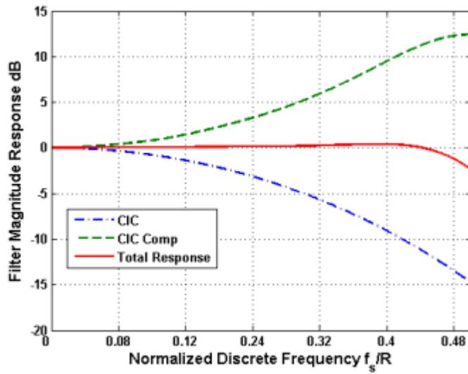
由于 CIC Filter 存在的问题是通带不够平坦，阻带不够可以通过多级 CIC Filter 级联满足要求，所以通过 CIC Compensation Filter 对 CIC Filter 进行反向补偿，实现 CIC Filter 满足较大的通带带宽和阻带的要求。
