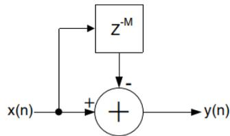
梳状滤波器，如图 2-3 所示。梳状滤波器是对称 FIR 滤波器。
