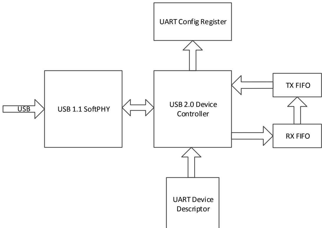
在本设计实例中，USB 经过 Gowin USB 1.1 SoftPHY IP 模块转成并行 UTMI 信号，在经过 USB 2.0 Device Controller 完成了 USB 数据包解析，UART Device Descriptor 模块内部包含了 USB 设备描述符信息，UART
