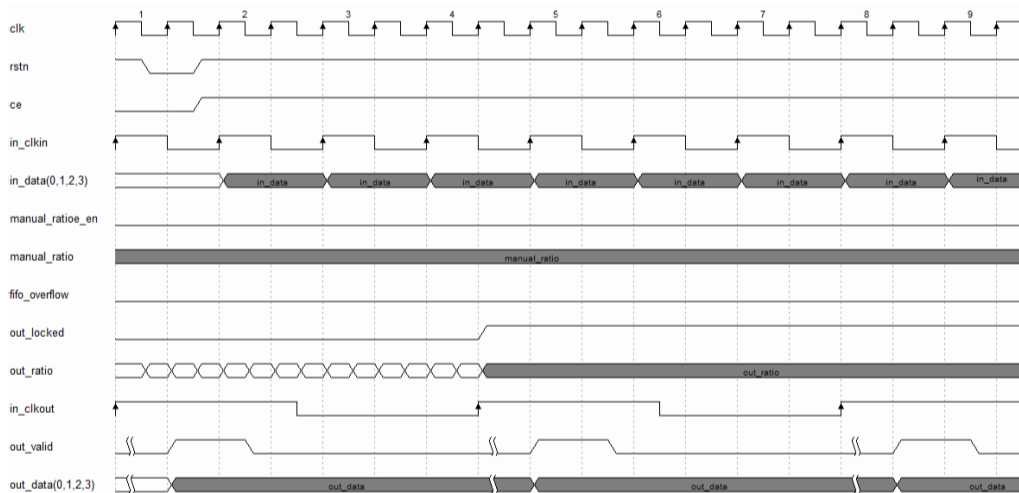
图 4-3 ASRC 自动检测采样率模式时序图
