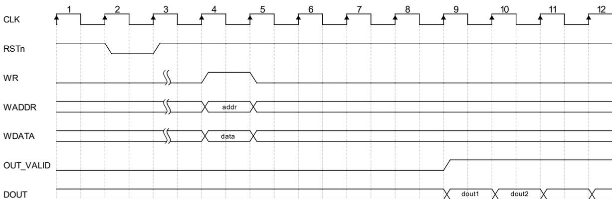
单通道模式下，数据可以通过 IP 配置直接输出，无需写入控制字；也可以通过寄存器接口（WR、WADDR、WDATA）写入数据从而改变相位增量及相位偏移量。
