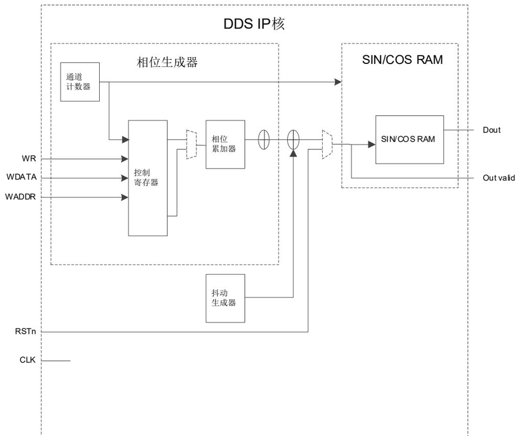
用户通过提供 CLK 时钟信号并配置相应参数，可使 DDS IP 输出指定频率的正弦波信号。
