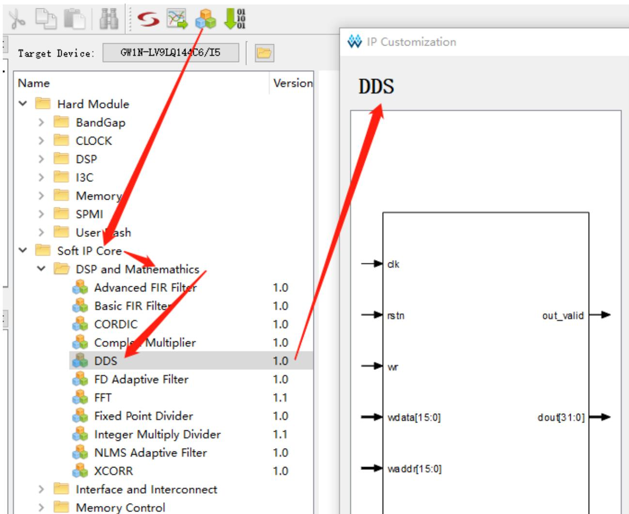
图 7-2 DDS IP 配置界面
