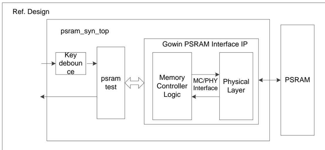
在参考设计中，psram\_syn\_top 模块是顶层模块单元，其端口连接输入参考时钟、外部复位等信号，端口连接如表 7-1 所示。psram\_test 用于产生 Gowin PSRAM Interface HS IP 所需的地址、数据与读写等命令，并且该模块单元可综合。Key\_debounce 模块是一个消抖模块，用于消除由按键或拨码开关控制外部激励时产生的信号抖动。
