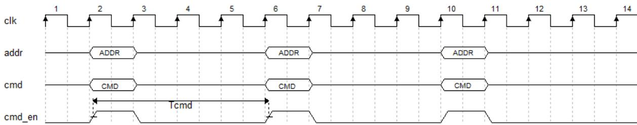
在用户端实际使用时两个命令（写-读/读-写/写-写/读-读）间隔需满足最小间隔周期（图 4-8 中 Tcmd 周期数），即突发长度为 16 时，命令间隔最小为 14 个时钟周期；突发长度为 32 时，命令间隔最小为 18 个时钟周期；突发长度为 64 时，命令间隔最小为 26 个时钟周期；突发长度为 128 时，命令间隔最小为 42 个时钟周期。如表 4-2 所示。
