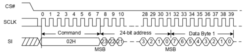
图 3-17 SPI Flash 写接口时序图
