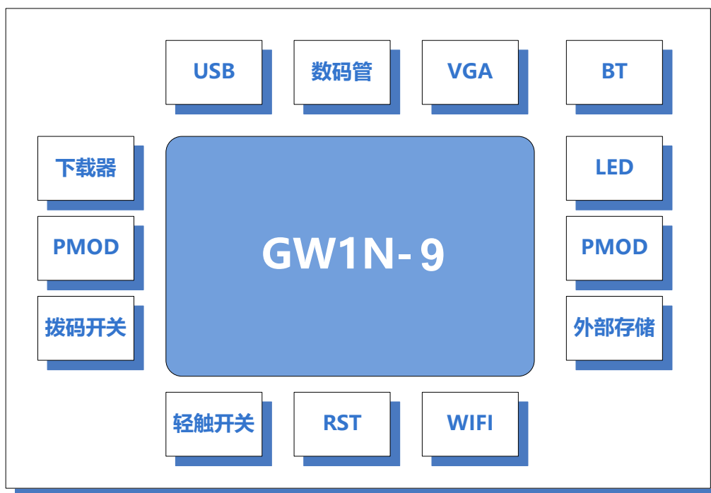
图2-4 Pocket Lab-F0开发板系统框架
