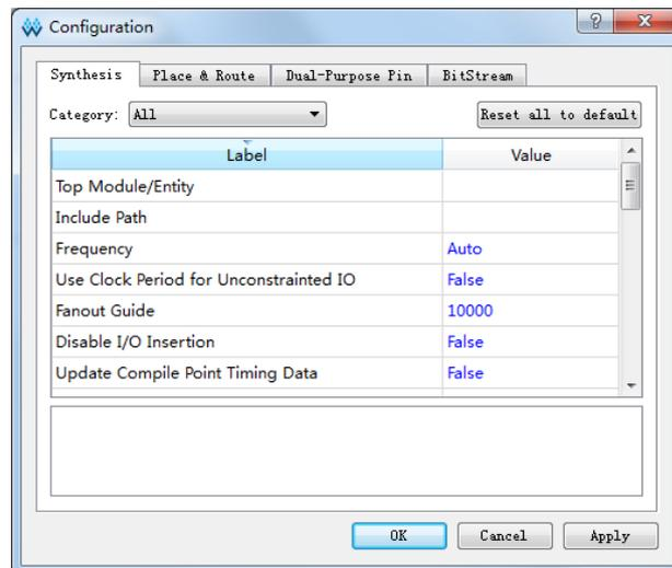
如图 5-30 所示，可配置的工程属性包含 Synthesis 属性、Place&Route 属性、Dual-Purpose Pin 属性以及 Bitstream 属性：
