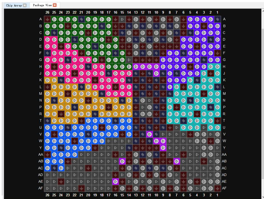
Package View 支持 IO Port 约束位置的显示, 可以通过从 Netlist 窗口或底部 I/O Constraints 窗口中将 IO Port 拖拽到 Package View 窗口来约束 IO Port 的位置。拖拽时鼠标处会显示拖拽 Port 的名称, 并且不可约束管脚呈现置灰不可拖拽状态。
