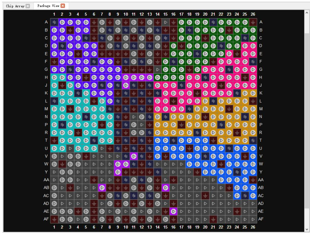
用户 I/O、电源、地管脚使用不同的符号和颜色来区分。不同 BNAK 的 IO 引脚的颜色不同，图中管脚符号定义如下所示：
