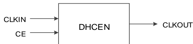
图 6-11 DHCEN 结构框图
