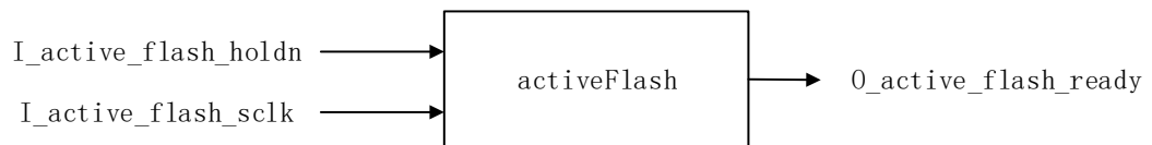
图 8-11 activeFlash 端口示意图
