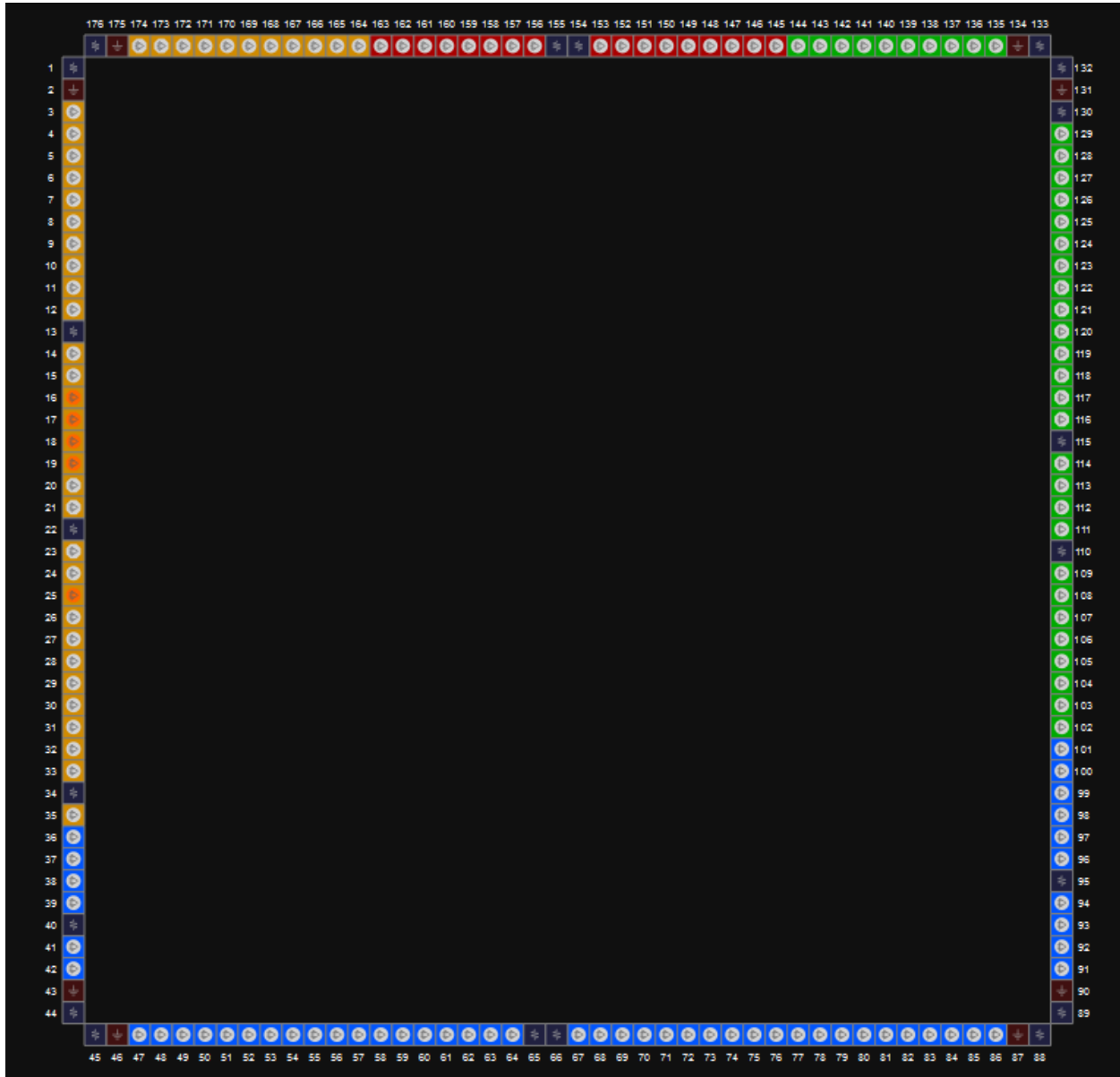
图 3-48 GW1N-9 器件 LQ176 封装管脚分布示意图（顶视图）
