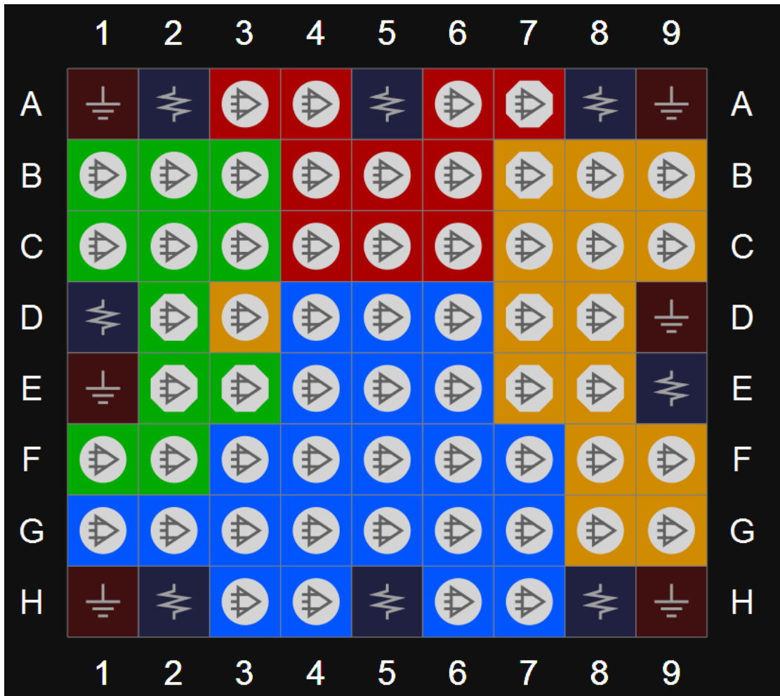
图 3-10 GW1N-2 器件 CS72 封装管脚分布示意图（顶视图）
