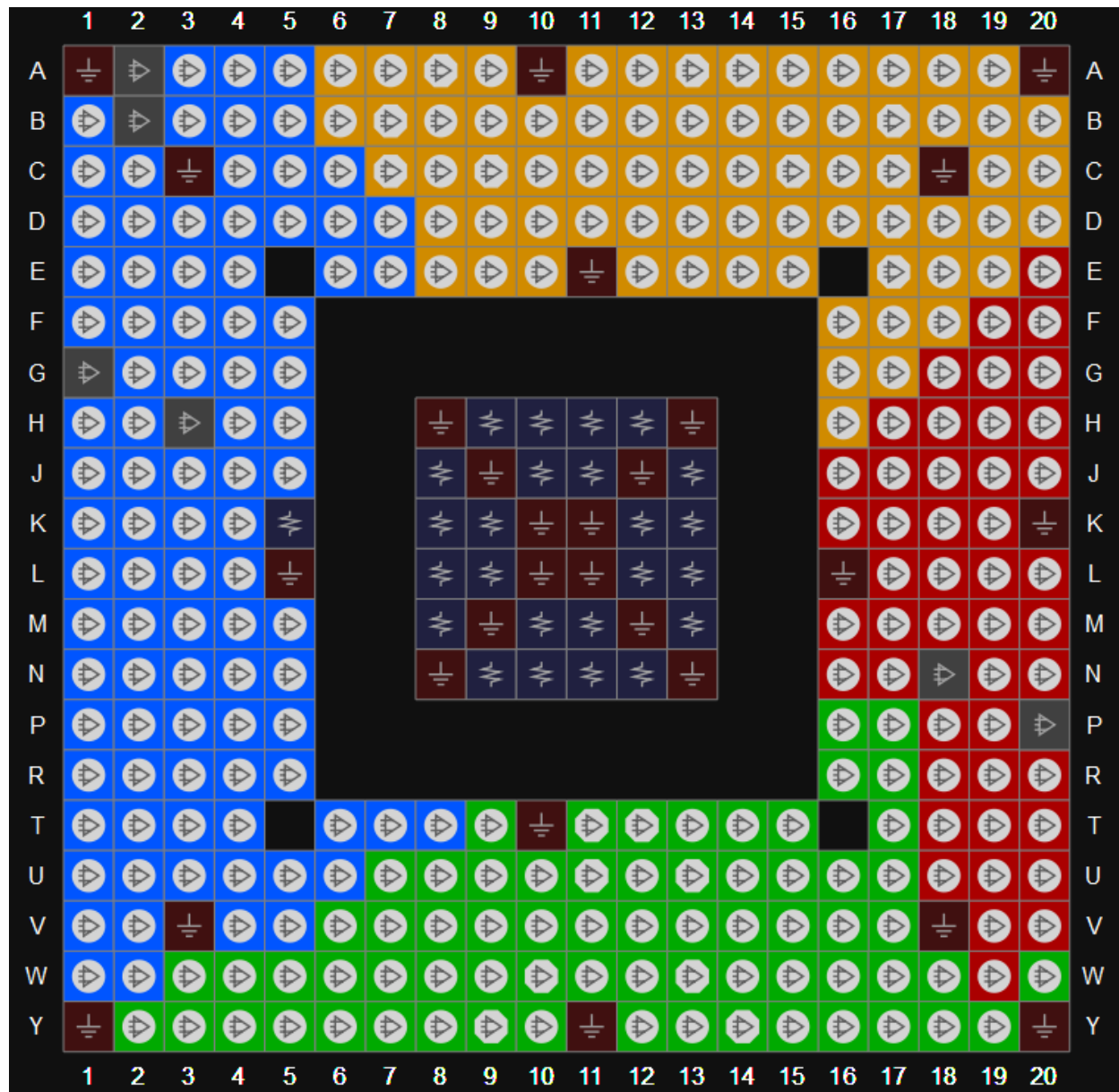
图 3-53 GW1N-9 器件 UG332 管脚分布示意图（顶视图）
