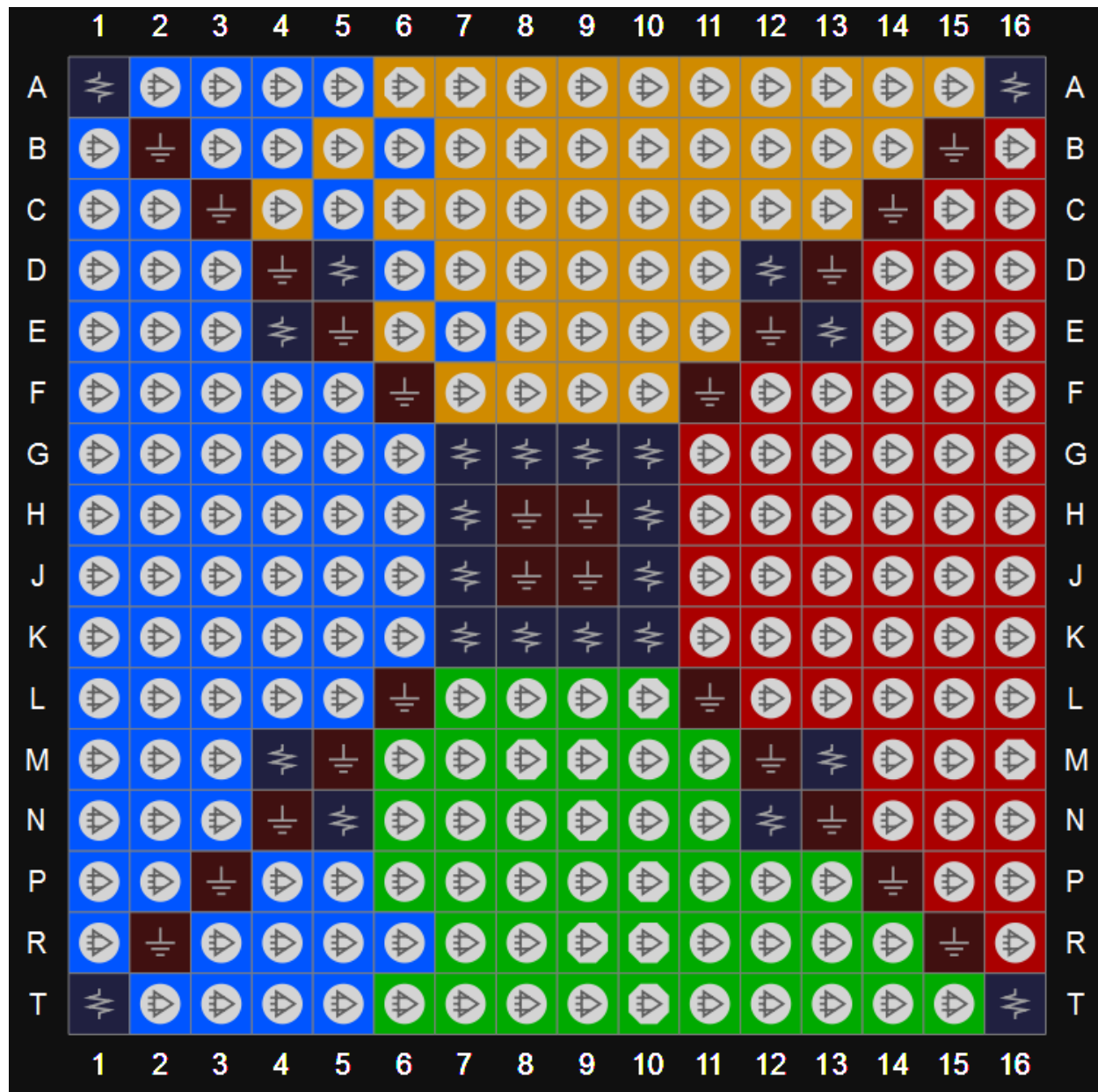
图 3-24 GW1N-4 器件 PG256 封装管脚分布示意图（顶视图）
