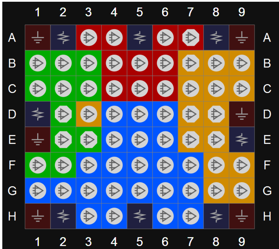
图 3-19 GW1N-4 器件 CS72 封装管脚分布示意图（顶视图）
