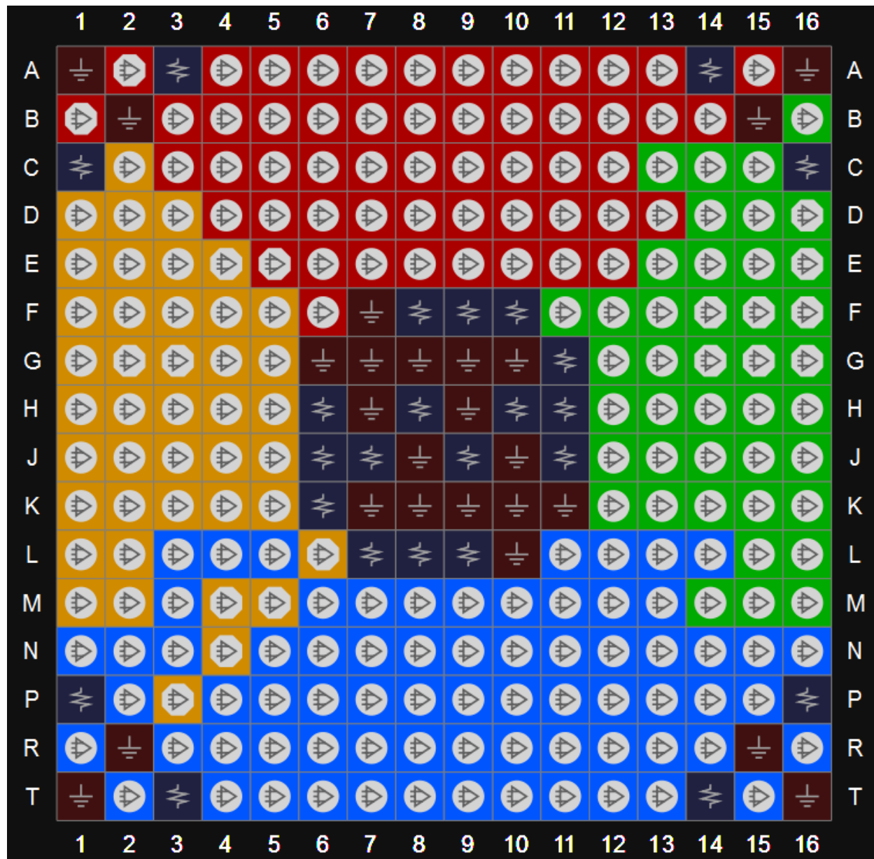
图 3-25 GW1N-4 器件 PG256M 封装管脚分布示意图（顶视图）
