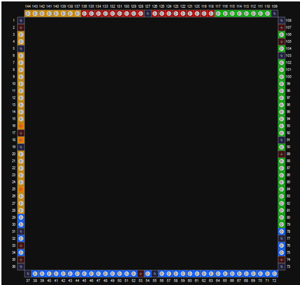
图 3-44 GW1N-9 器件 LQ144 封装管脚分布示意图（顶视图）
