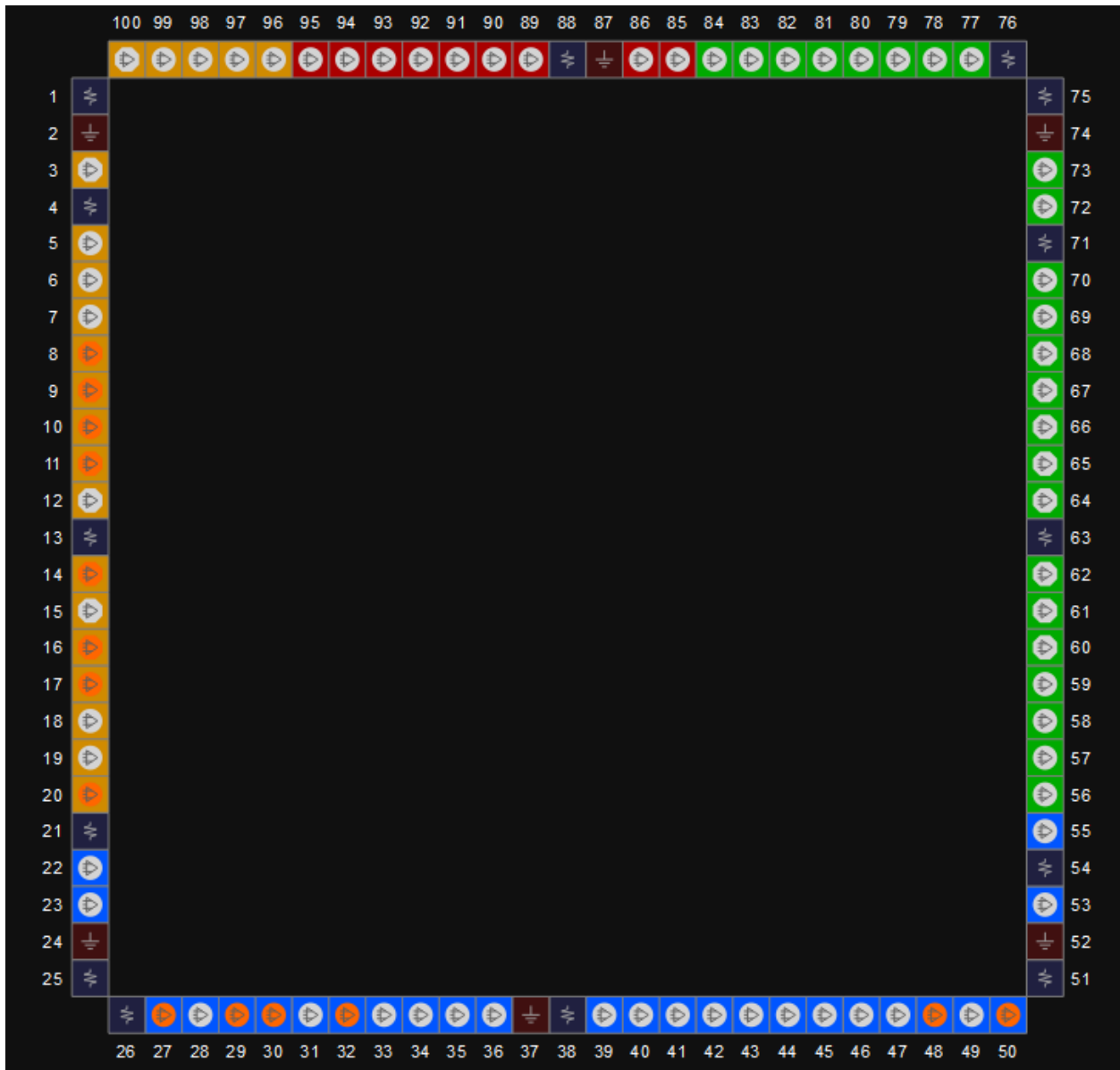
图 3-43 GW1N-9 器件 LQ100 封装管脚分布示意图（顶视图）
