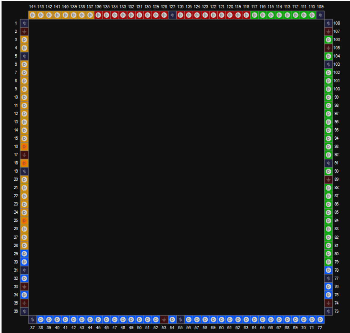
图 3-30 GW1N-6 器件 LQ144 封装管脚分布示意图（顶视图）
