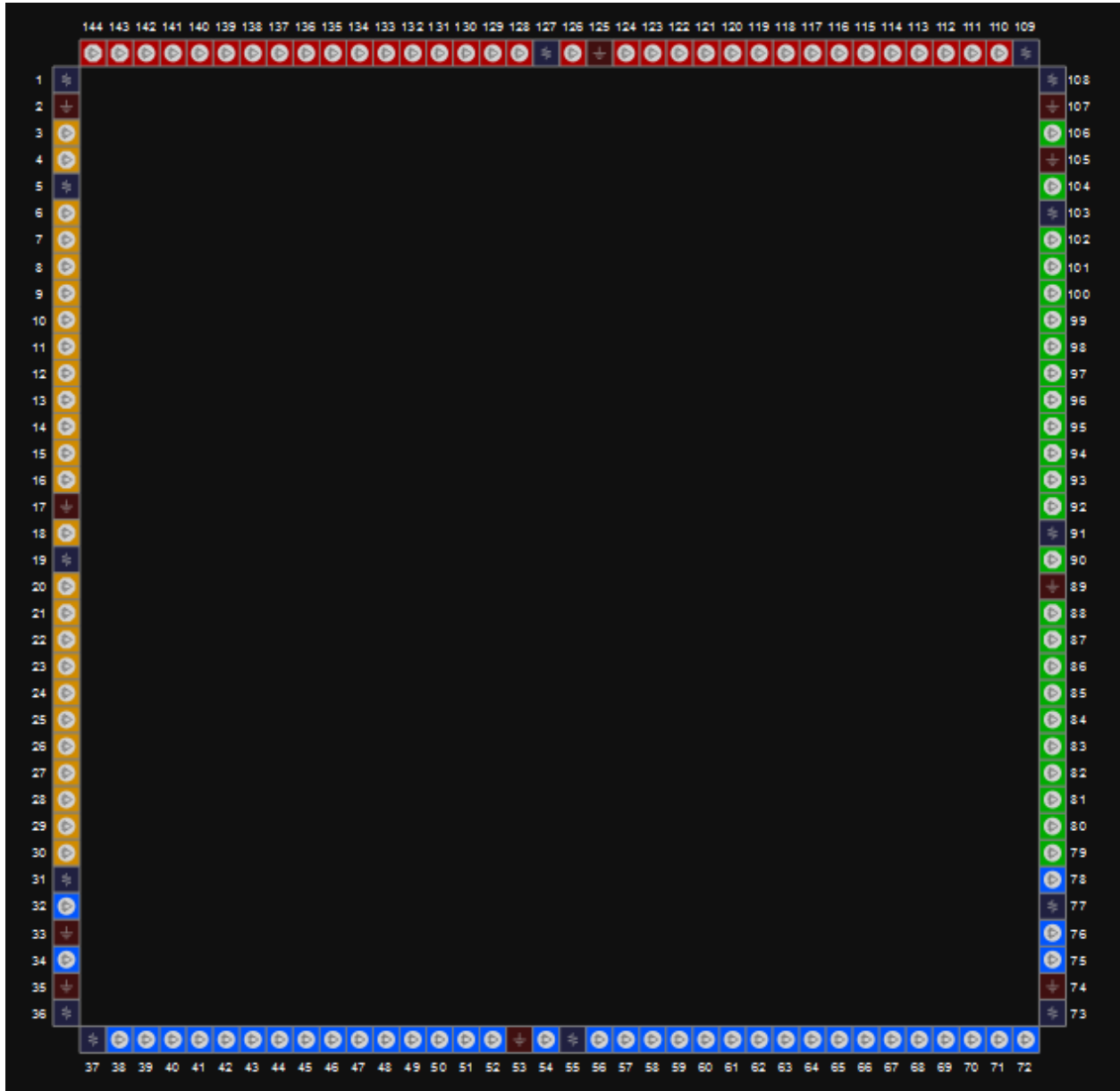
图 3-22 GW1N-4 器件 LQ144 封装管脚分布示意图（顶视图）
