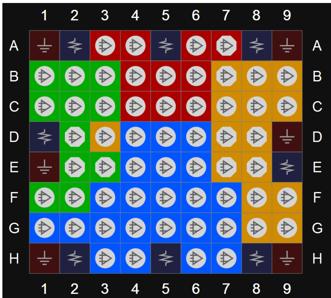
图 3-12 GW1N-2/GW1N-2B 器件 CS72 封装管脚分布示意图（顶视图）
