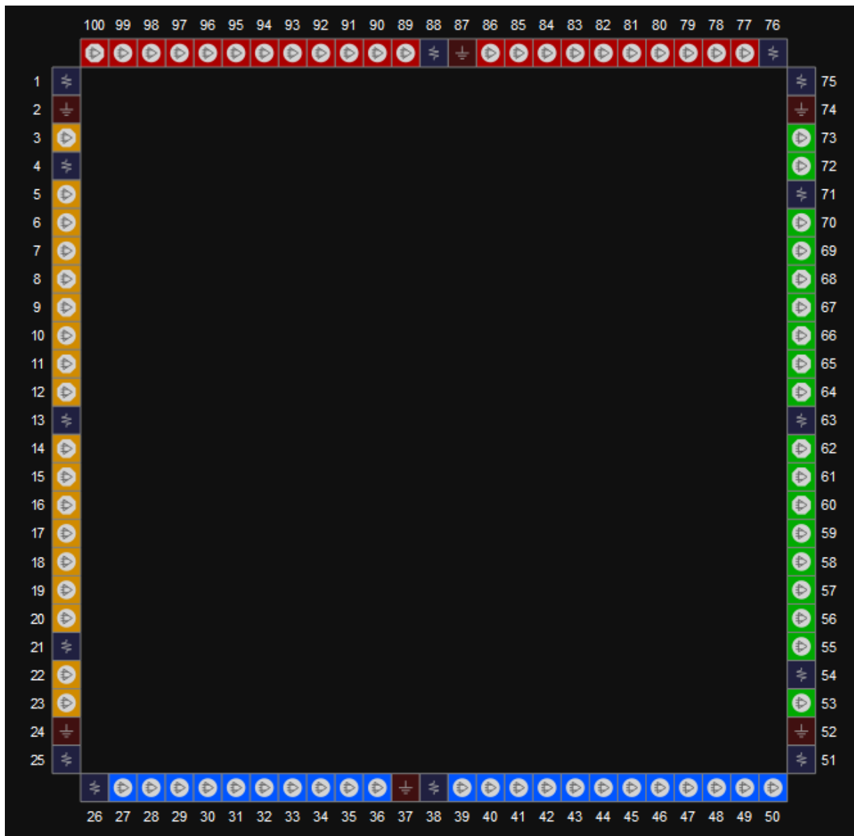
图 3-7 GW1N-1 器件 LQ100 封装管脚分布示意图（顶视图）
