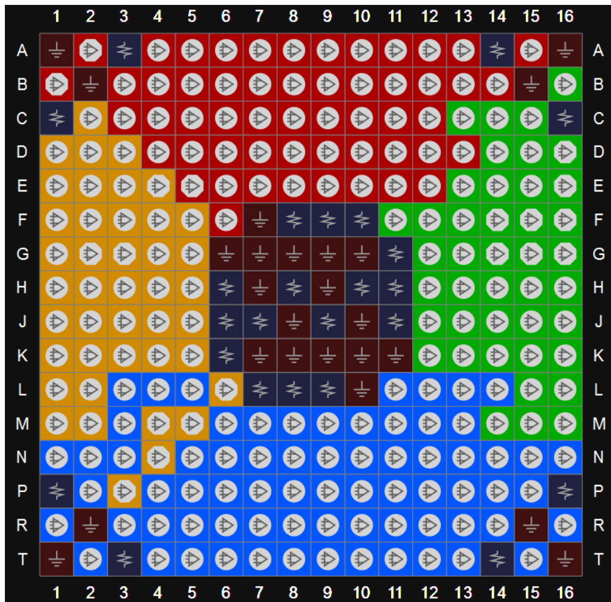
图 3-28 GW1N-4/GW1N-4B 器件 PG256M 封装管脚分布示意图（顶视图）
