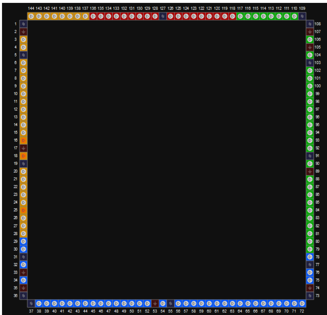
图 3-33 GW1N-6 器件 LQ144 封装管脚分布示意图（顶视图）
