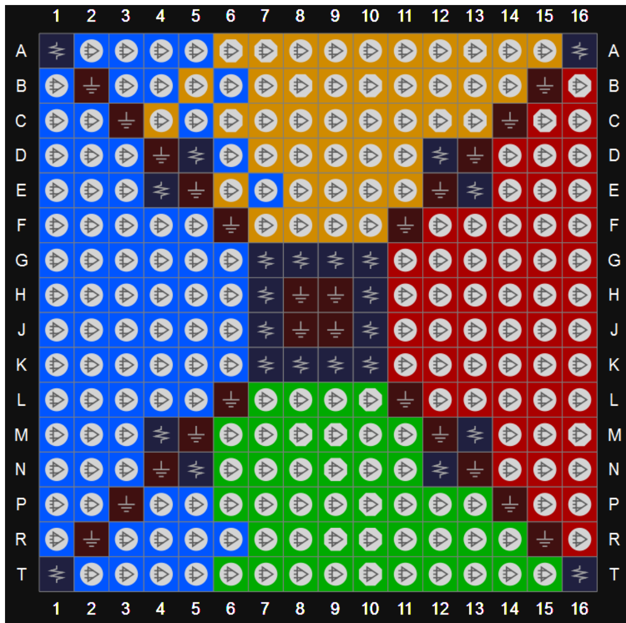
图 3-17 GW1N-2/GW1N-2B 器件 PG256 封装管脚分布示意图（顶视图）
