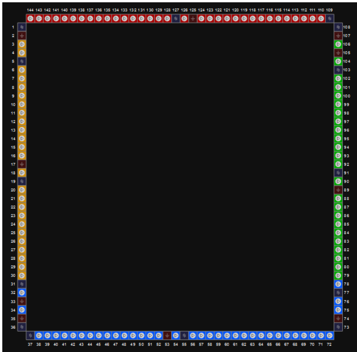
图 3-25 GW1N-4/GW1N-4B 器件 LQ144 封装管脚分布示意图（顶视图）
