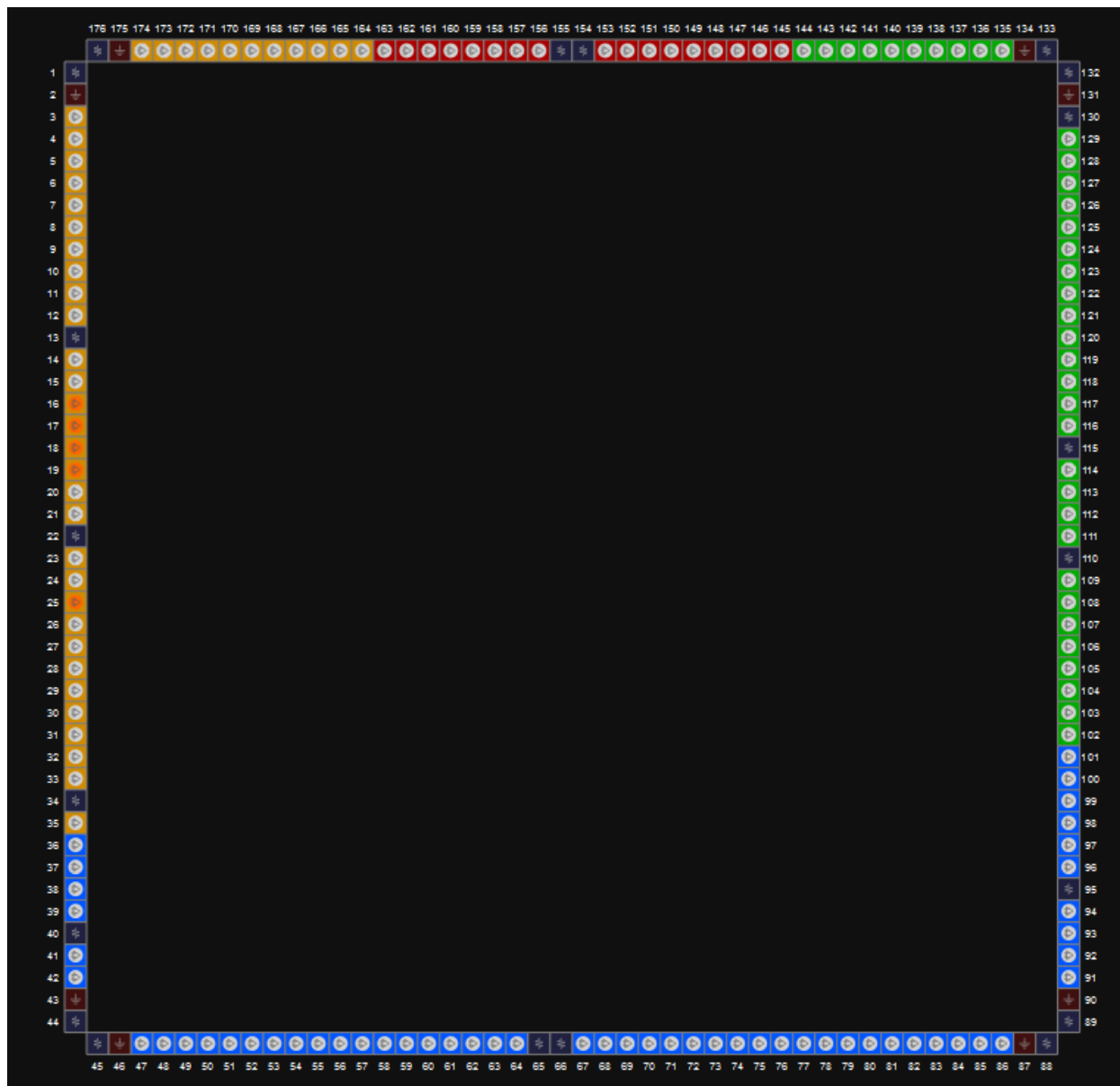
图 3-51 GW1N-9 器件 LQ176 封装管脚分布示意图（顶视图）
