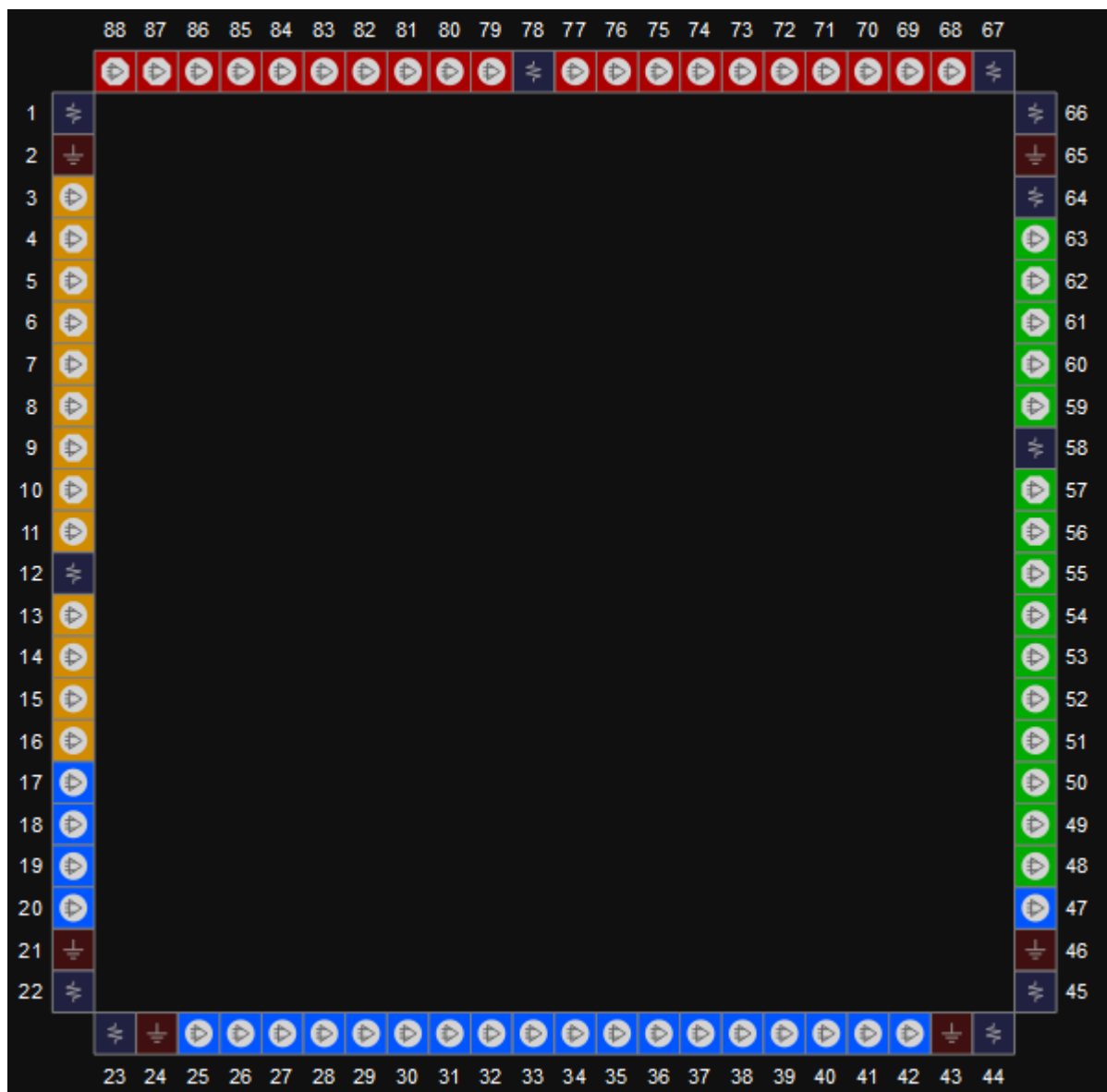
图 3-22 GW1N-4/GW1N-4B 器件 QN88 封装管脚分布示意图（顶视图）
