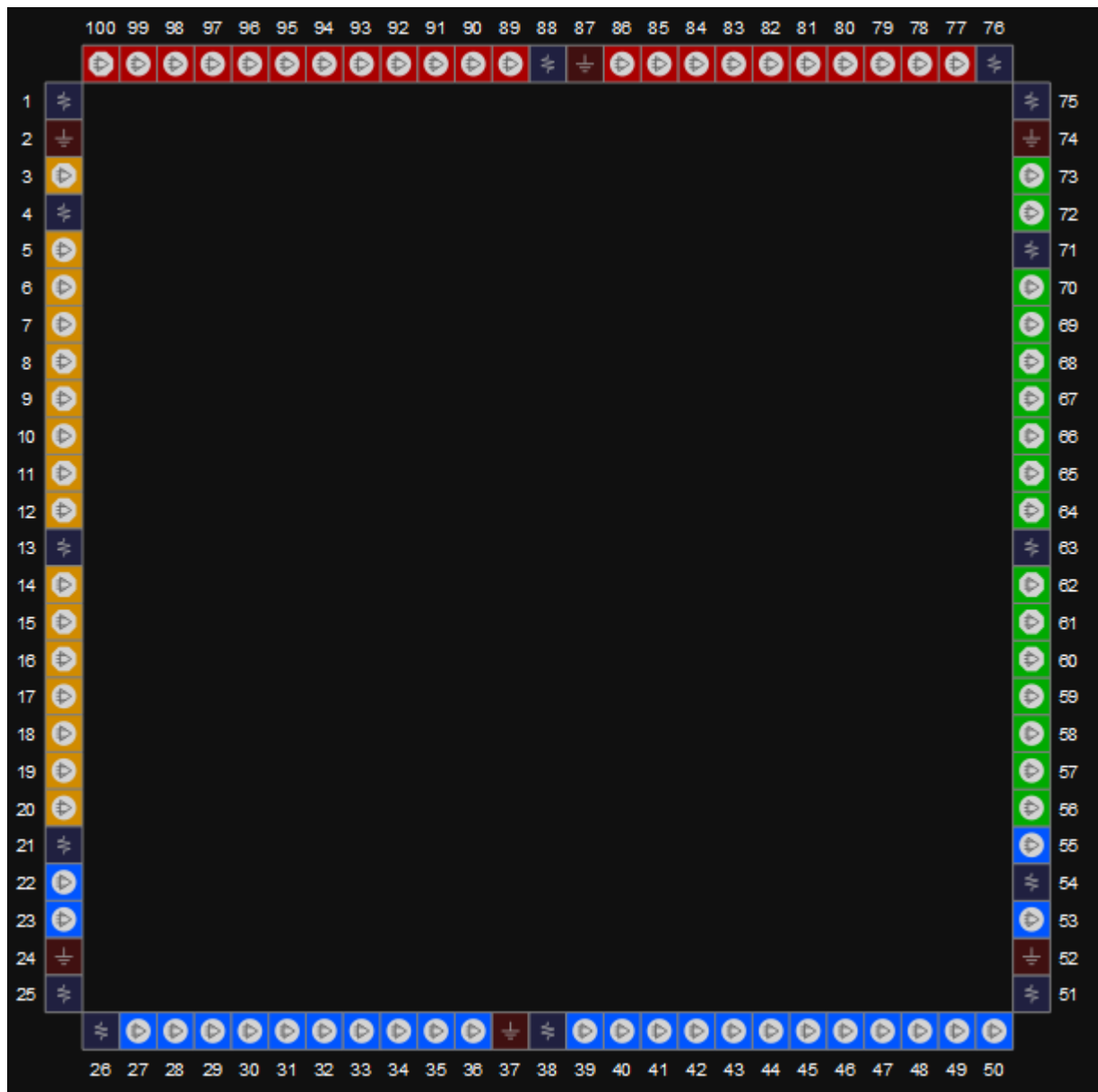
图 3-23 GW1N-4/GW1N-4B 器件 LQ100 封装管脚分布示意图（顶视图）
