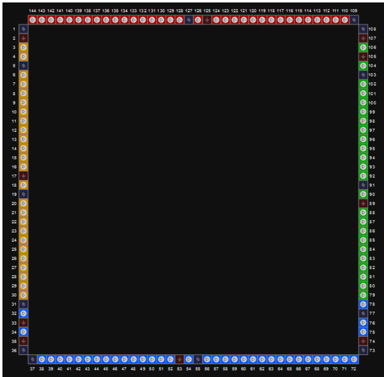
图 3-15 GW1N-2/GW1N-2B 器件 LQ144 封装管脚分布示意图（顶视图）
