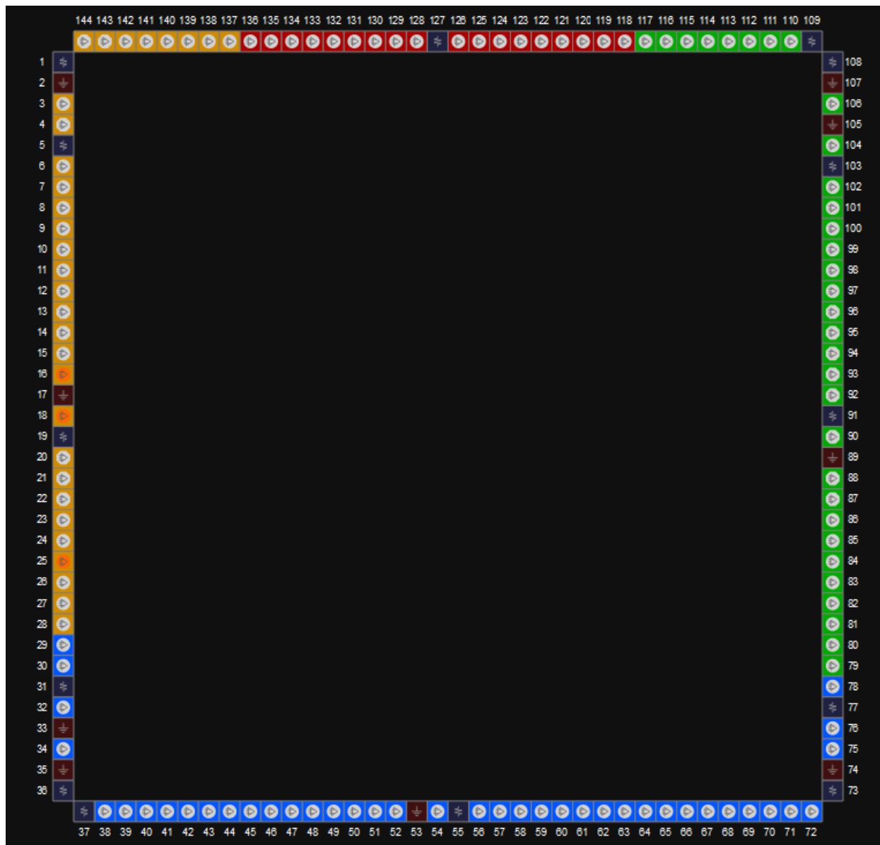
图 3-47 GW1N-9 器件 LQ144 封装管脚分布示意图（顶视图）
