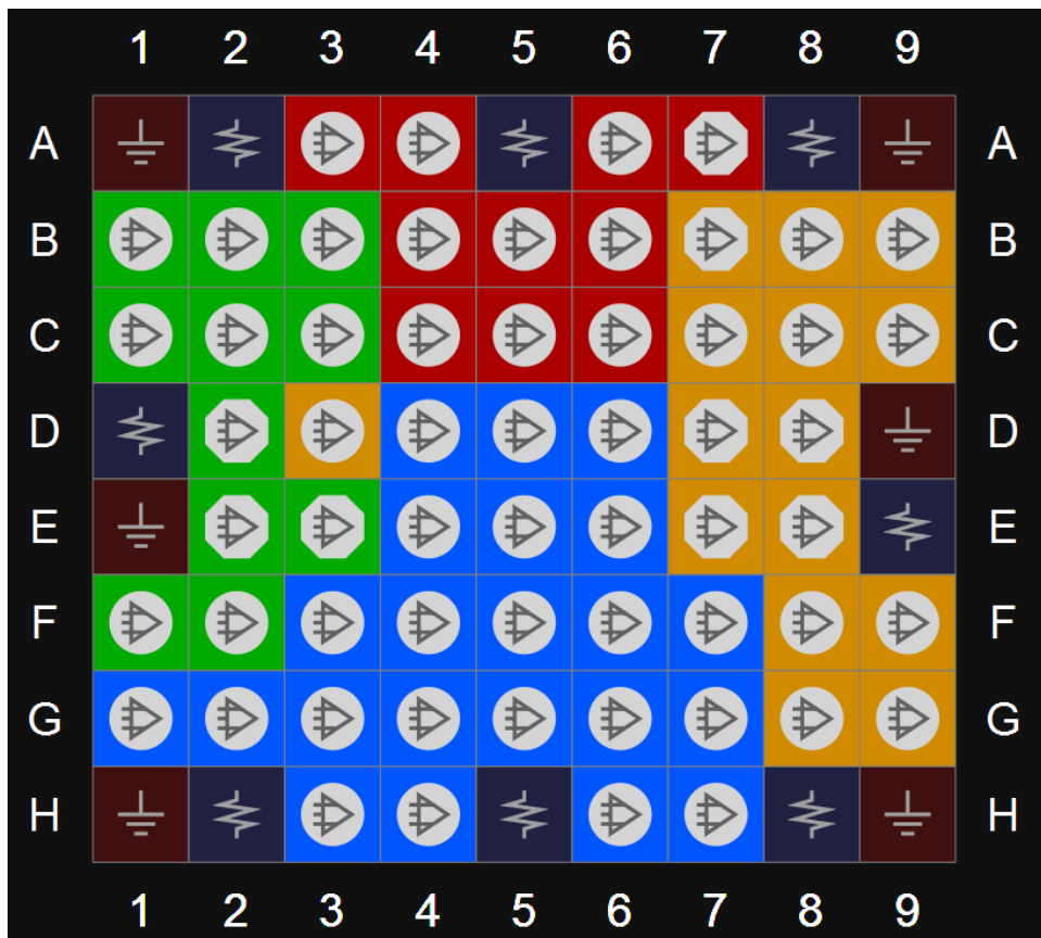
图 3-21 GW1N-4/GW1N-4B 器件 CS72 封装管脚分布示意图（顶视图）
