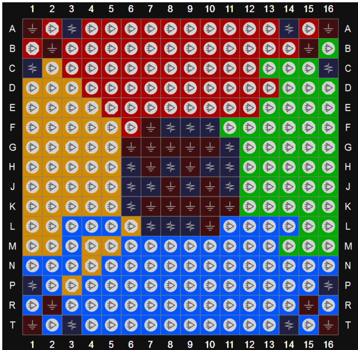
图 3-19 GW1N-4 器件 PG256M 封装管脚分布示意图（顶视图）
