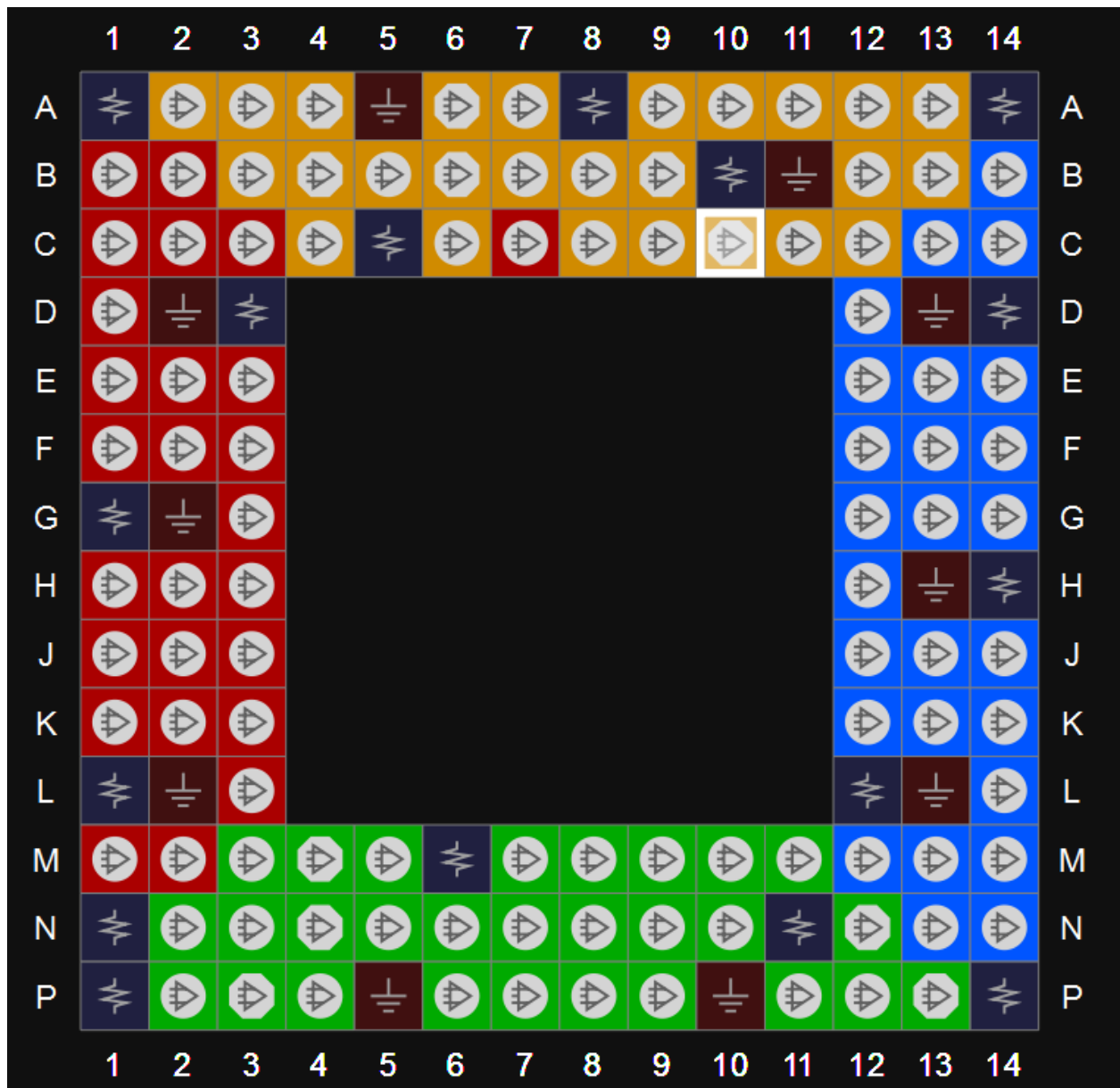
图 3-15 GW1N-4 器件 MG132X 封装管脚分布示意图（顶视图）
