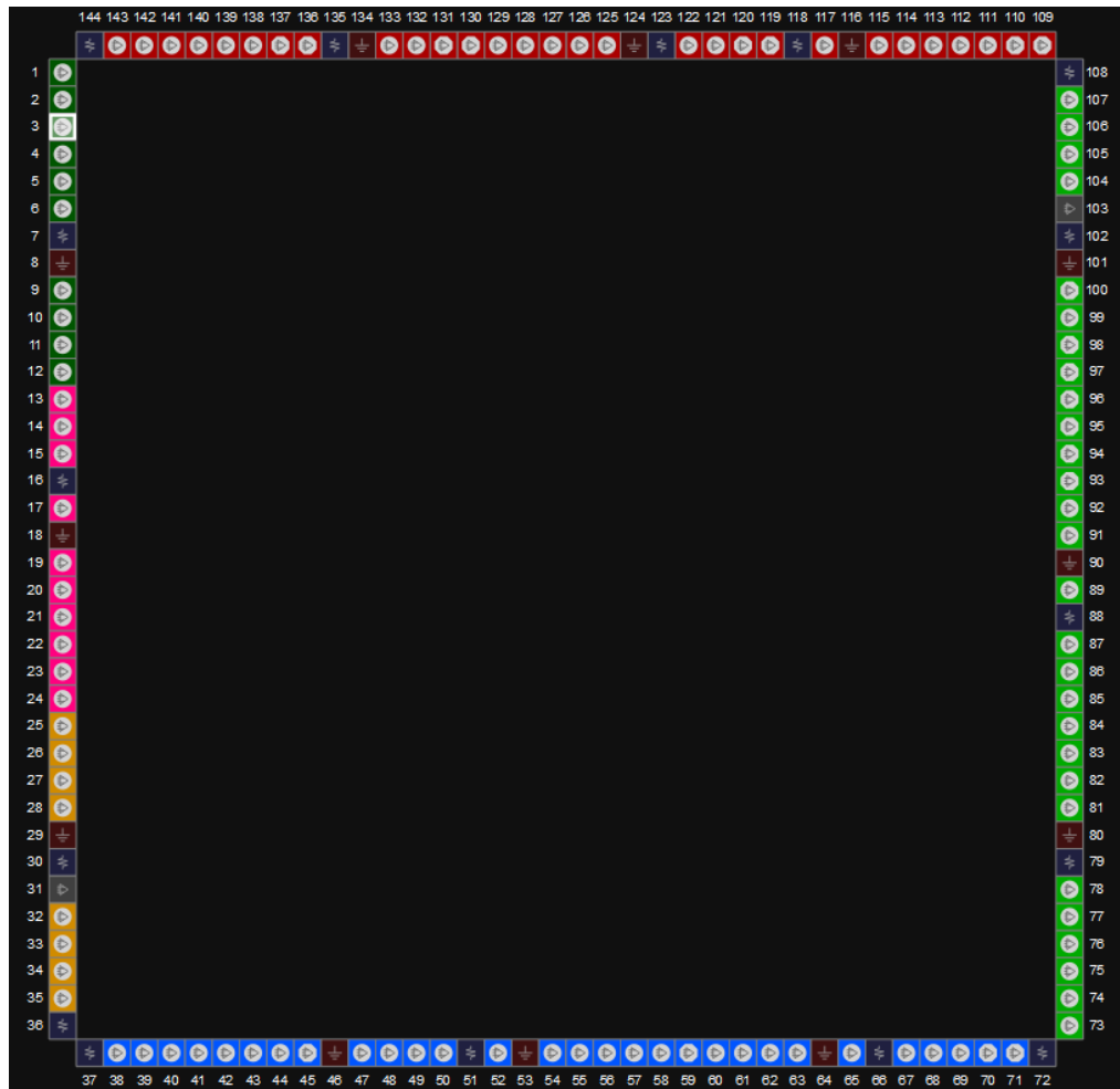
图 3-17 GW1N-2 器件 LQ144 封装管脚分布示意图（UV 版本,顶视图）
