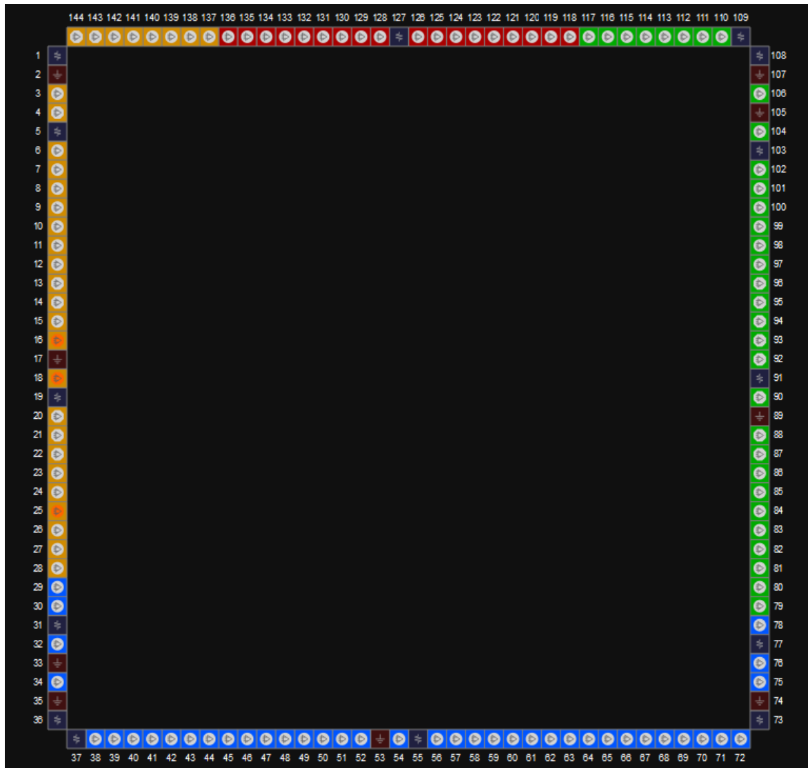
图 3-49 GW1N-9 器件 EQ144 封装管脚分布示意图（顶视图）
