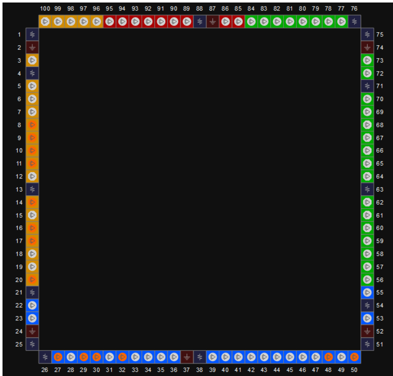
图 3-46 GW1N-9 器件 LQ100 封装管脚分布示意图（顶视图）
