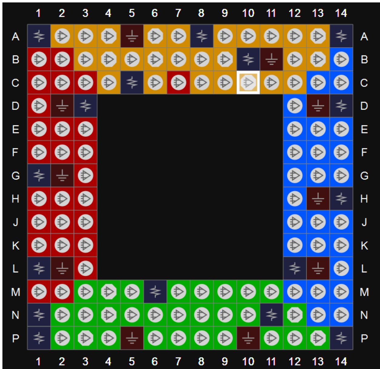
图 3-37 GW1N-4 器件 MG132X 封装管脚分布示意图（顶视图）
