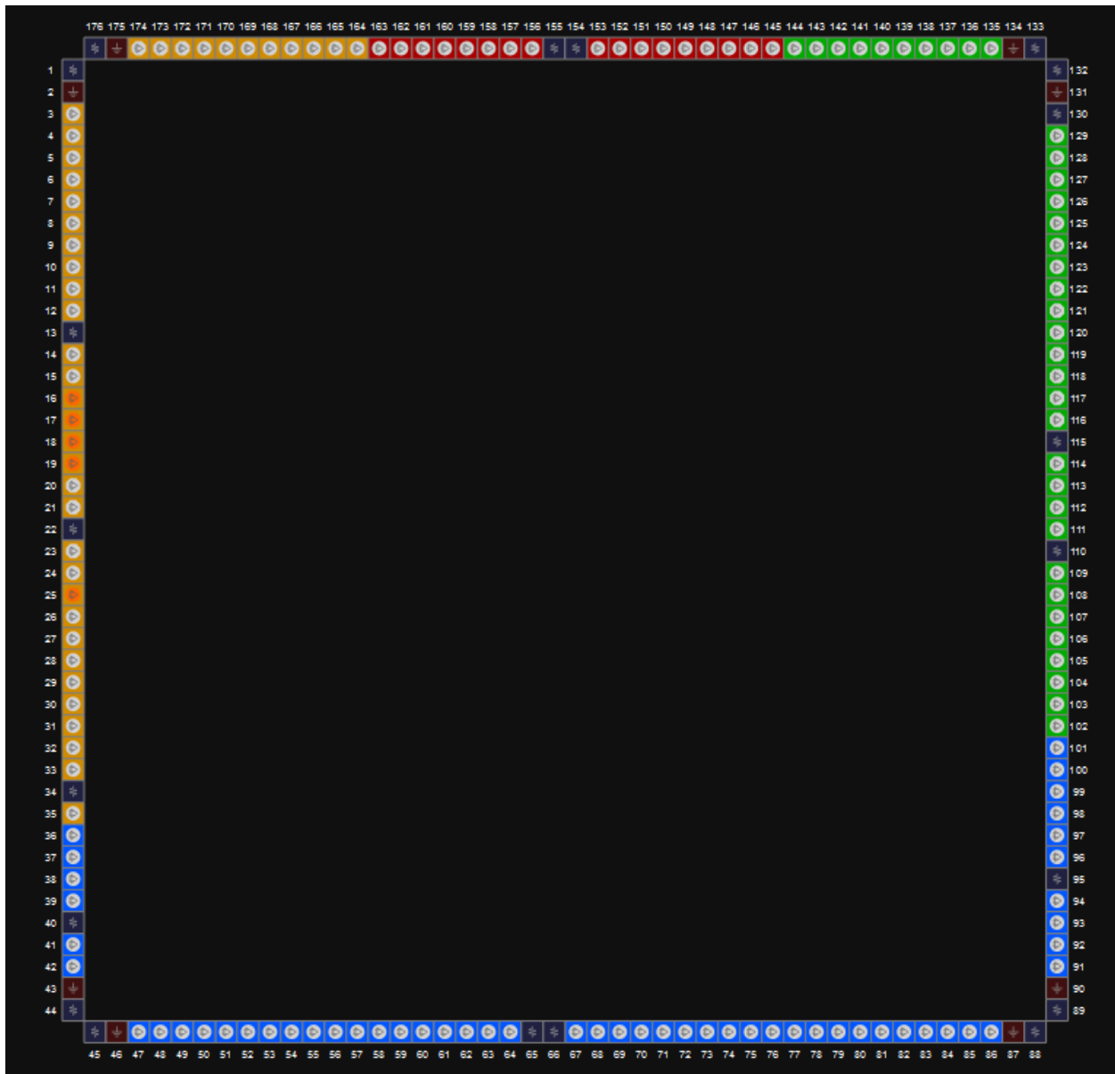
图 3-53 GW1N-9 器件 EQ176 封装管脚分布示意图（顶视图）
