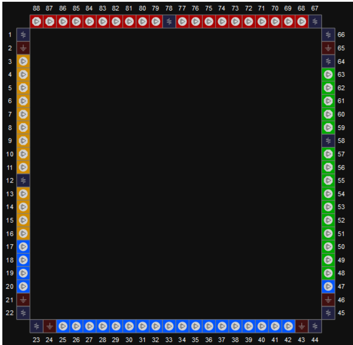
图 3-35 GW1N-4 器件 QN88 封装管脚分布示意图（顶视图）
