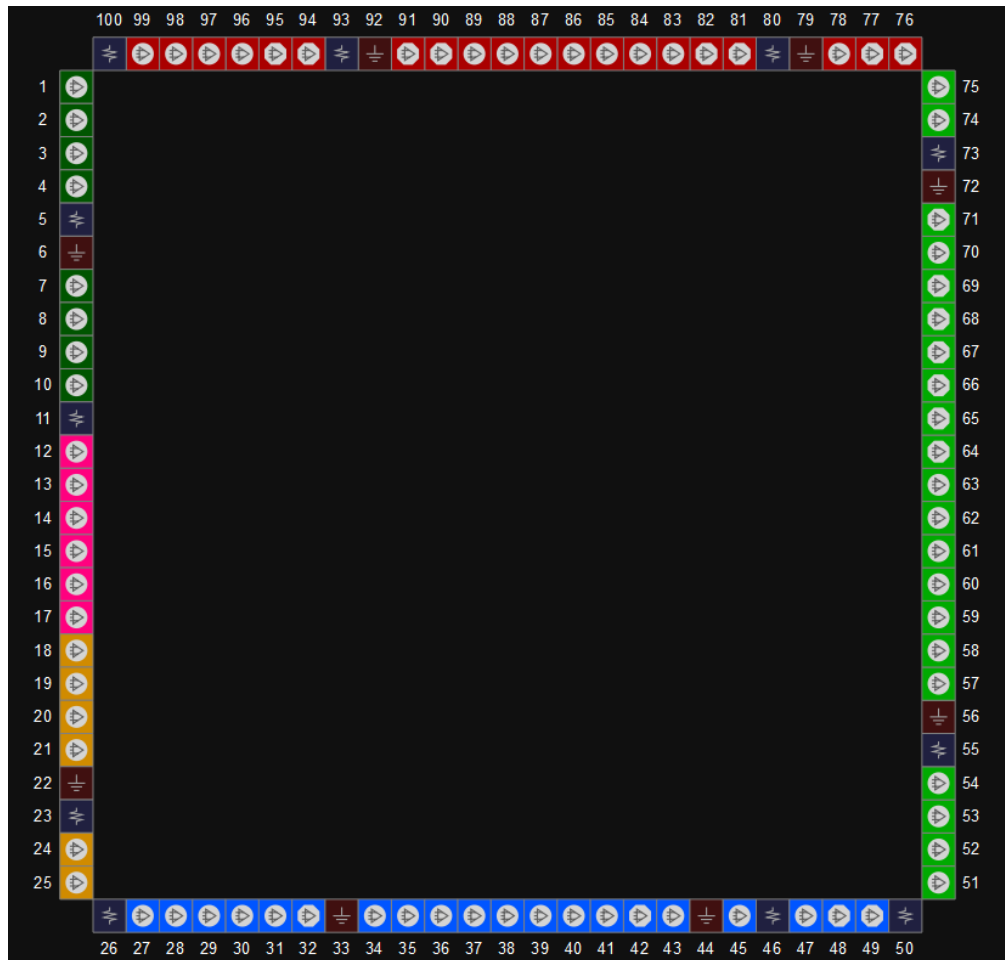
图 3-12 GW1N-2 器件 LQ100X 封装管脚分布示意图（LV 版本,顶视图）
