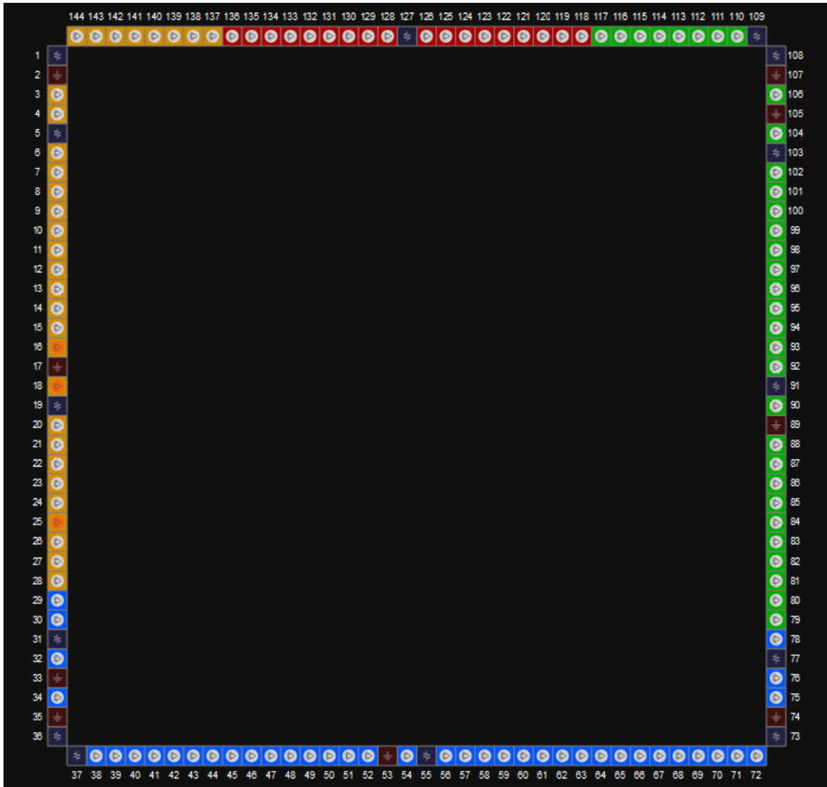
图 3-45 GW1N-9 器件 EQ144 封装管脚分布示意图（顶视图）
