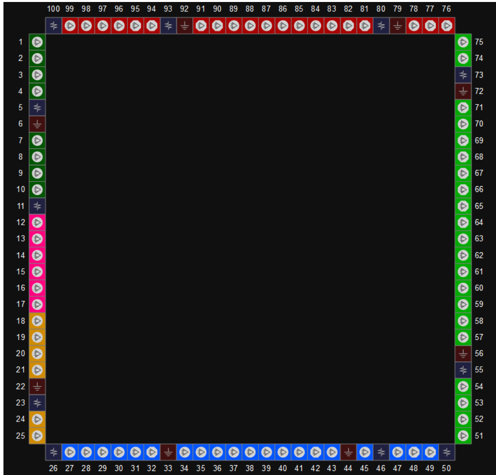
图 3-14 GW1N-2 器件 LQ100 封装管脚分布示意图 (LV 版本,顶视图)
