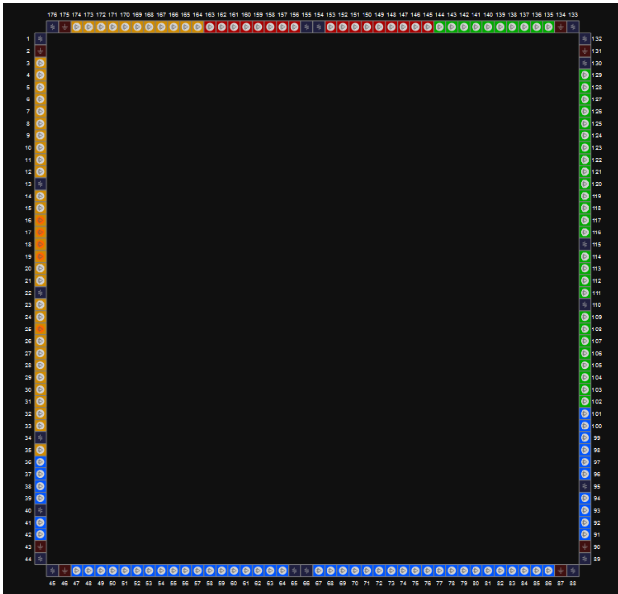
图 3-49 GW1N-9 器件 EQ176 封装管脚分布示意图（顶视图）
