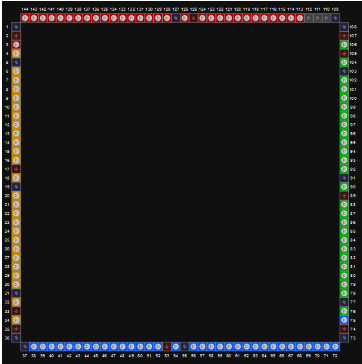
图 3-7 GW1N-1 器件 LQ144 封装管脚分布示意图（顶视图）
