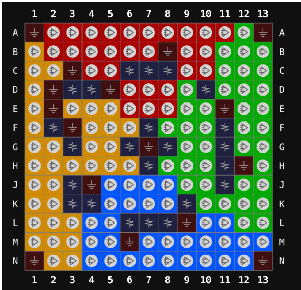
图 3-47 GW1N-9 器件 UG169 封装管脚分布示意图（顶视图）
