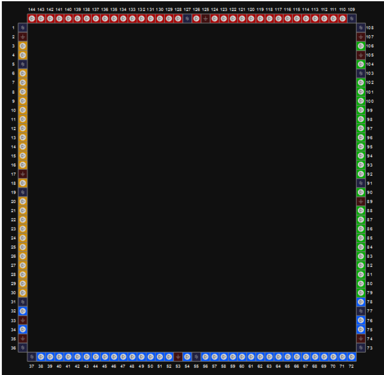
图 3-34 GW1N-4 器件 LQ144 封装管脚分布示意图（顶视图）
