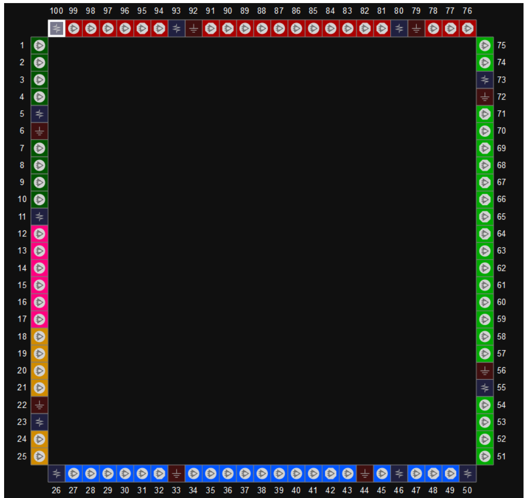
图 3-13 GW1N-2 器件 LQ100 封装管脚分布示意图 (UV 版本,顶视图)
