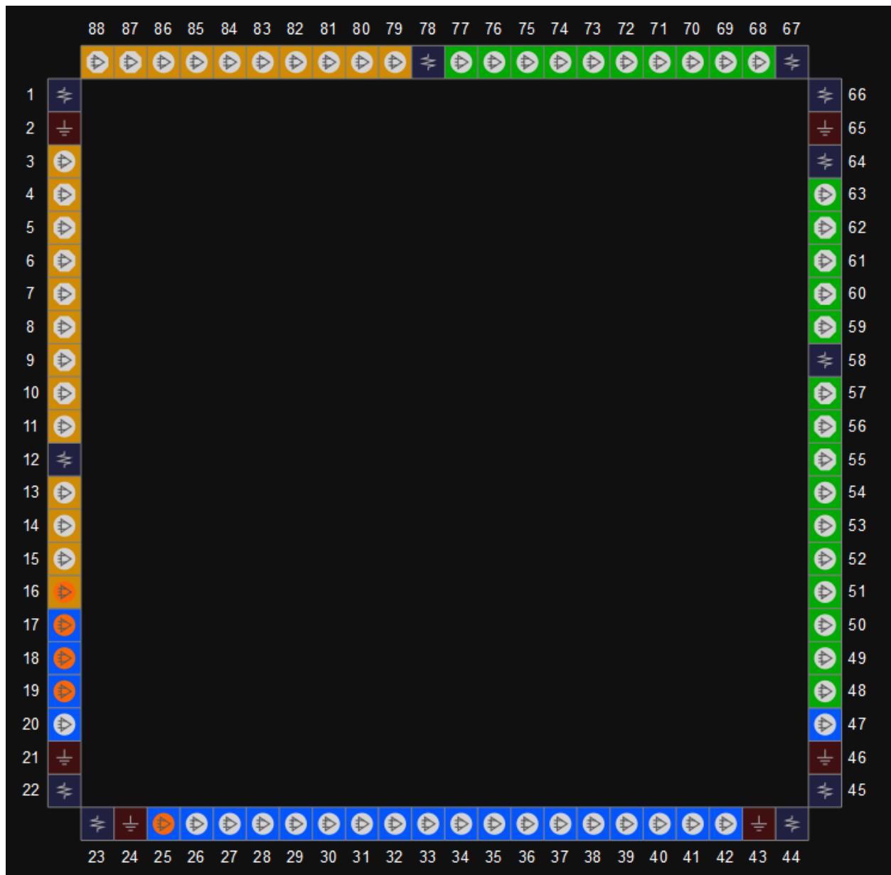
图 3-41 GW1N-9 器件 QN88 封装管脚分布示意图（顶视图）
