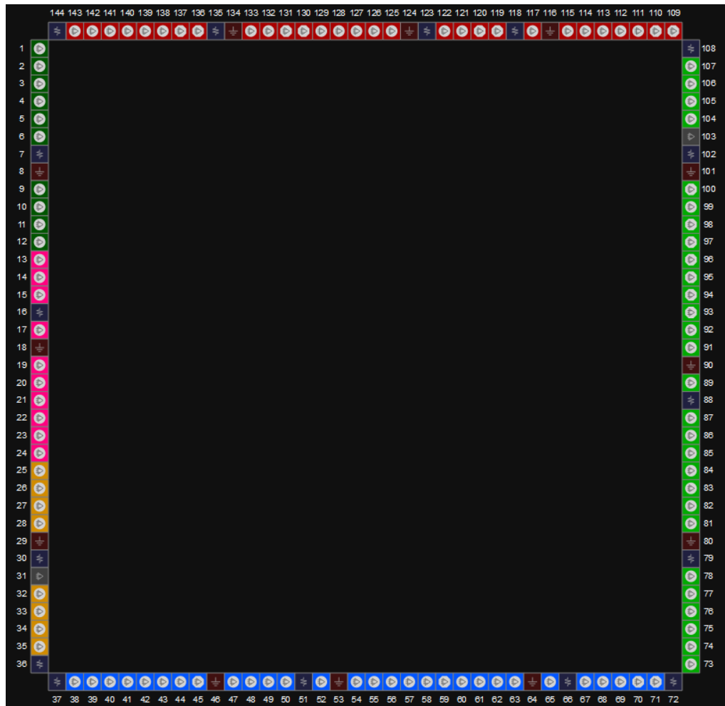
图 3-16 GW1N-2 器件 LQ144X 封装管脚分布示意图（LV 版本,顶视图）
