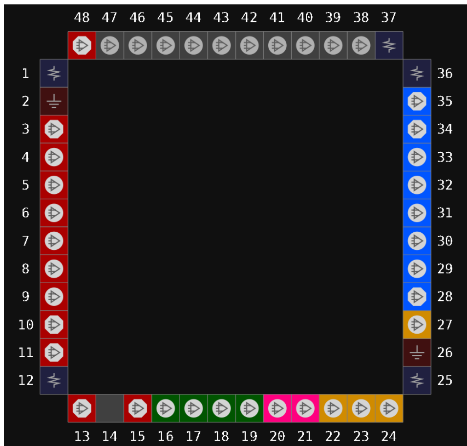
图 3-20 GW1N-2 器件 QN48H 封装管脚分布示意图（顶视图）
