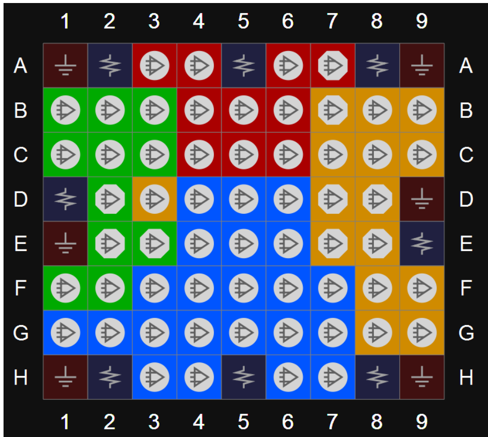
图 3-30 GW1N-4 器件 CS72 封装管脚分布示意图（顶视图）
