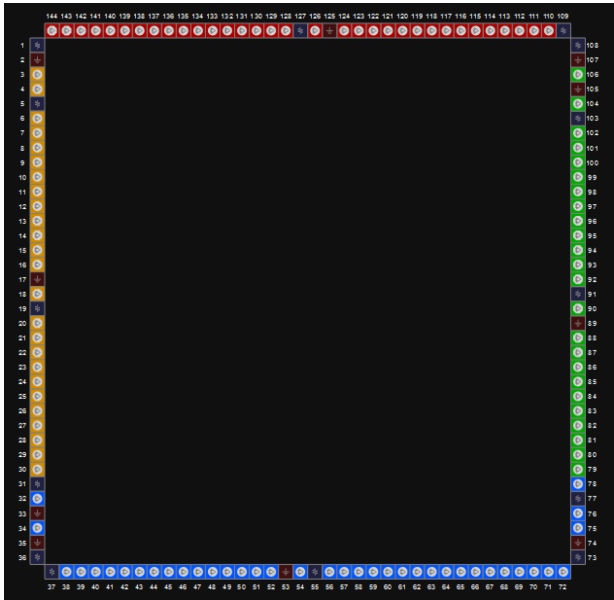
图 3-51 GW1N-4 器件 LQ144 封装管脚分布示意图（顶视图）
