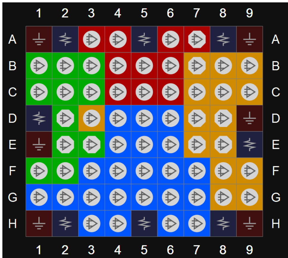
图 3-47 GW1N-4 器件 CS72 封装管脚分布示意图（顶视图）
