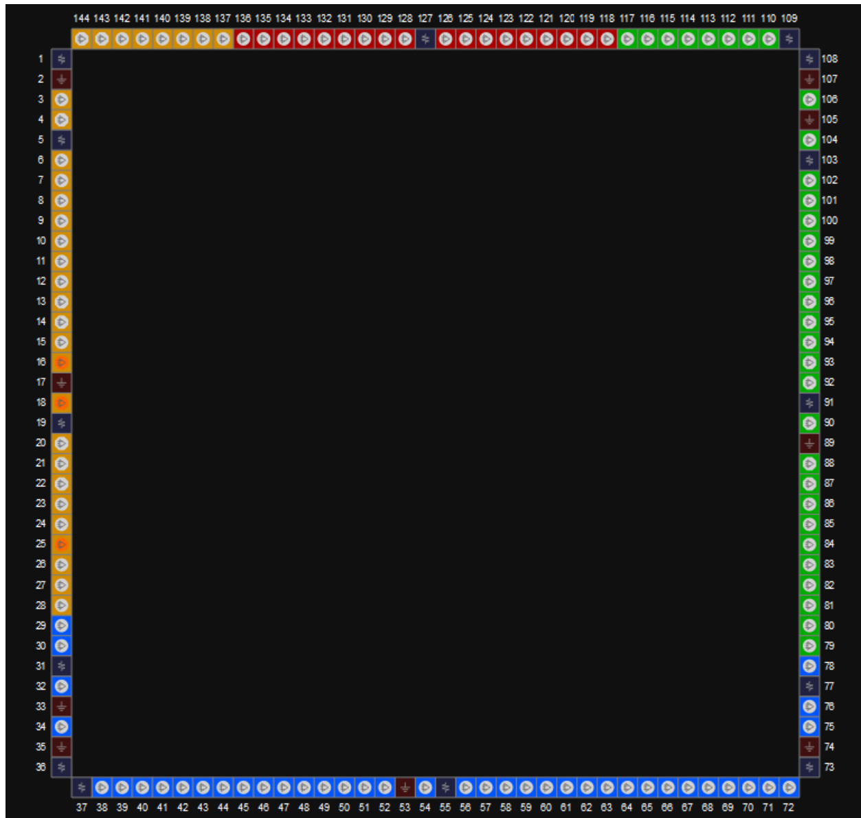
图 3-62 GW1N-9 器件 LQ144 封装管脚分布示意图（顶视图）
