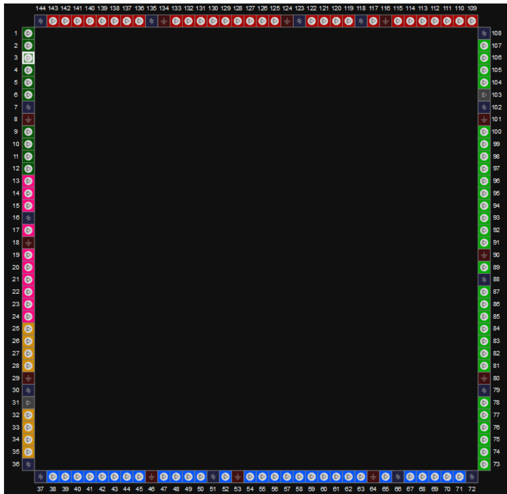
图 3-17 GW1N-2 器件 LQ144X 封装管脚分布示意图 (UV 版本,顶视图)
