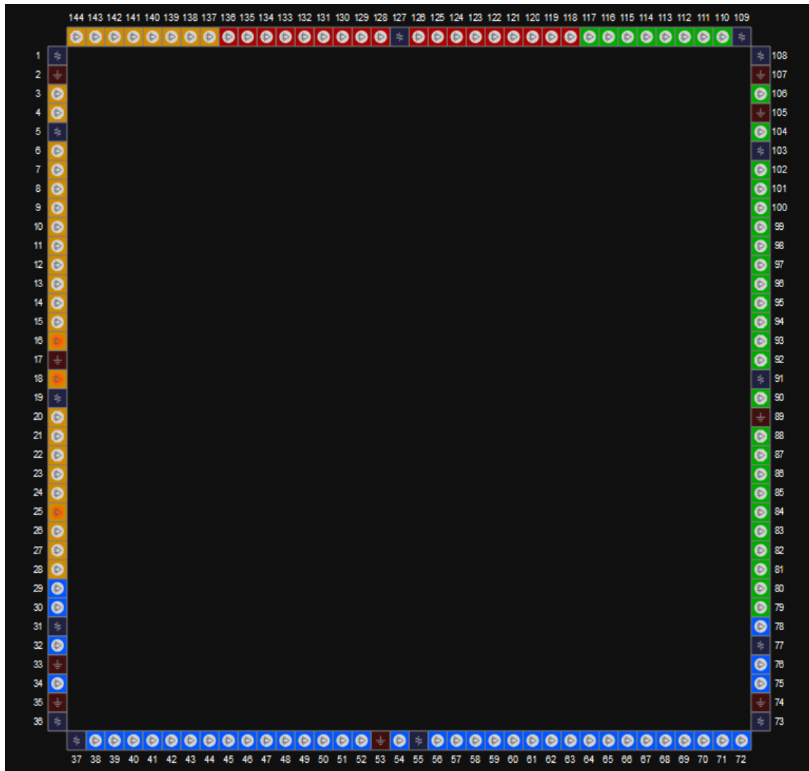
图 3-63 GW1N-9 器件 EQ144 封装管脚分布示意图（顶视图）
