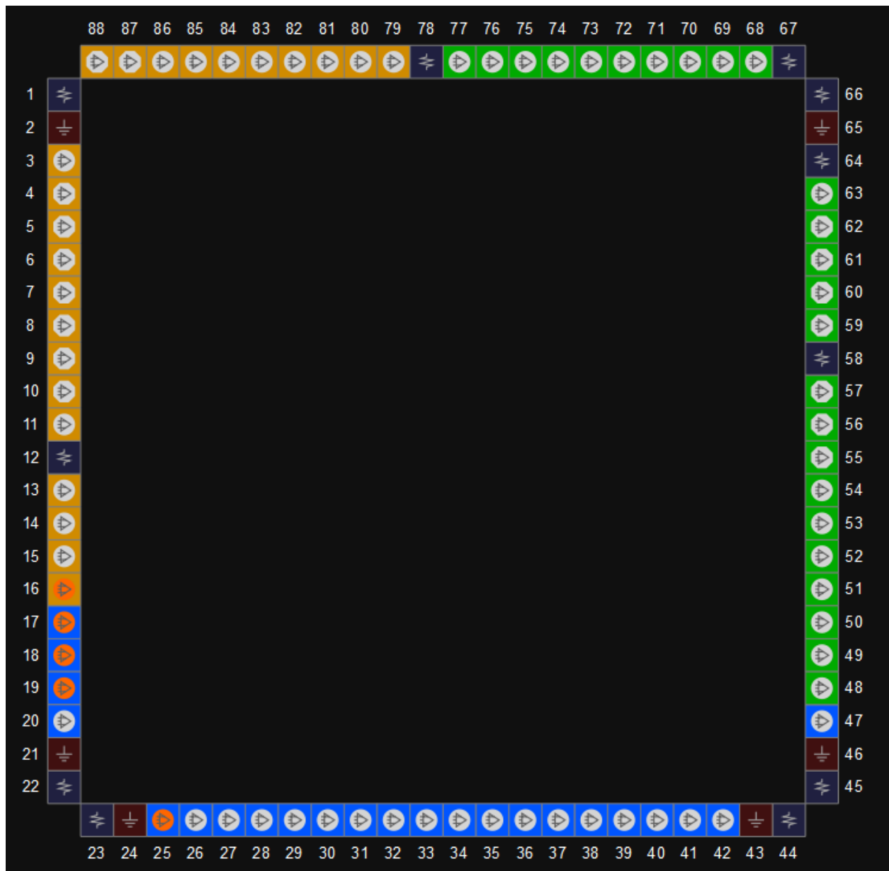
图 3-59 GW1N-9 器件 QN88 封装管脚分布示意图（顶视图）
