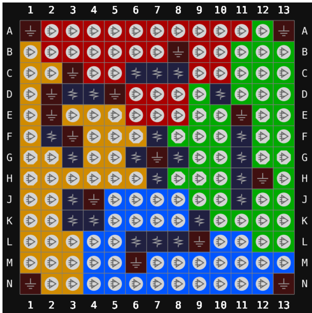
图 3-53 GW1N-4 器件 UG169 封装管脚分布示意图（顶视图）
