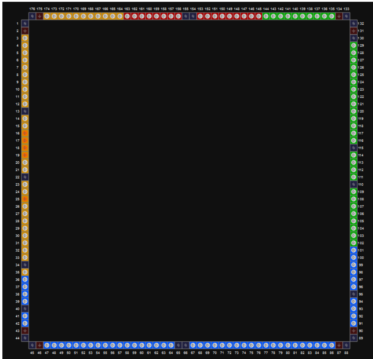
图 3-67 GW1N-9 器件 EQ176 封装管脚分布示意图（顶视图）
