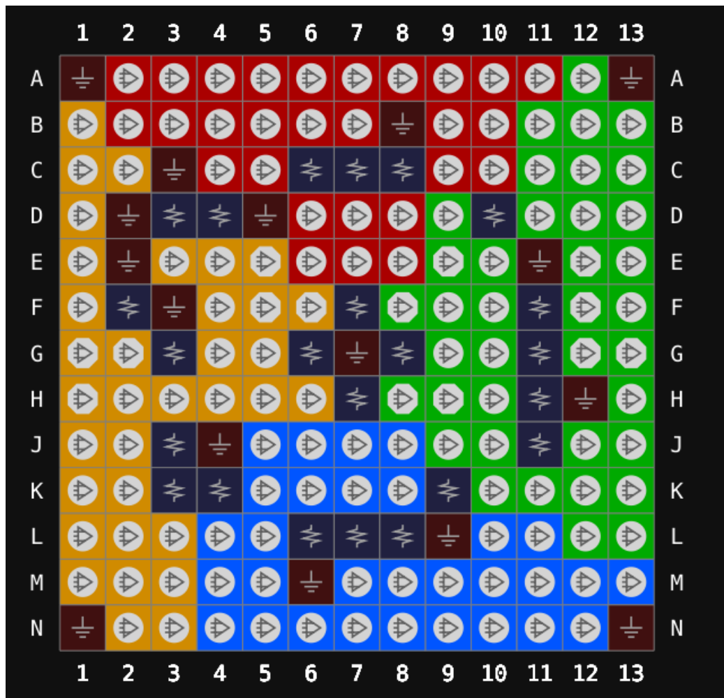
图 3-65 GW1N-9 器件 UG169 封装管脚分布示意图（顶视图）
