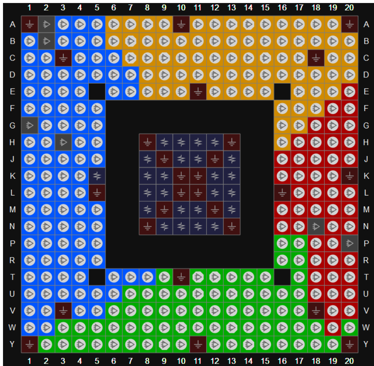
图 3-71 GW1N-9 器件 UG332 管脚分布示意图（顶视图）
