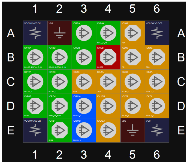
图 3-3 GW1N-1 器件 CS30 封装管脚分布示意图（顶视图）
