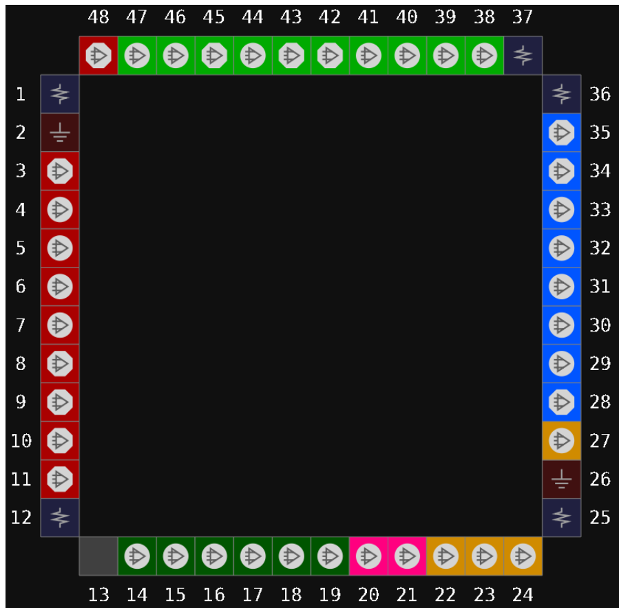
图 3-23 GW1N-2 器件 QN48 封装管脚分布示意图（顶视图）
