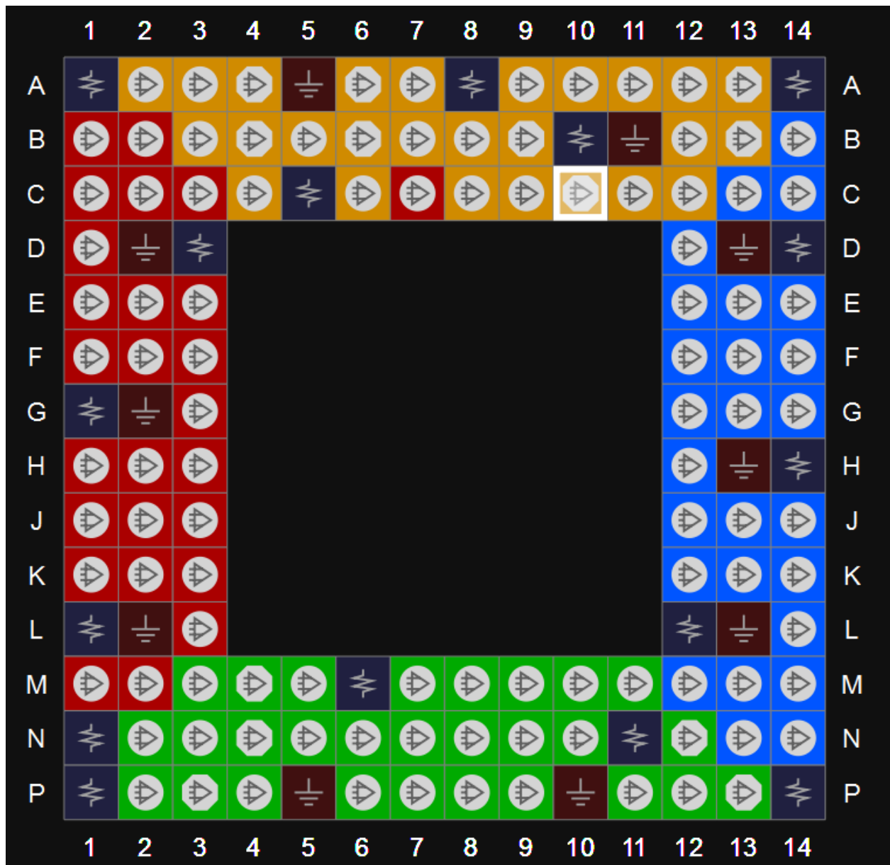
图 3-50 GW1N-4 器件 MG132X 封装管脚分布示意图（顶视图）
