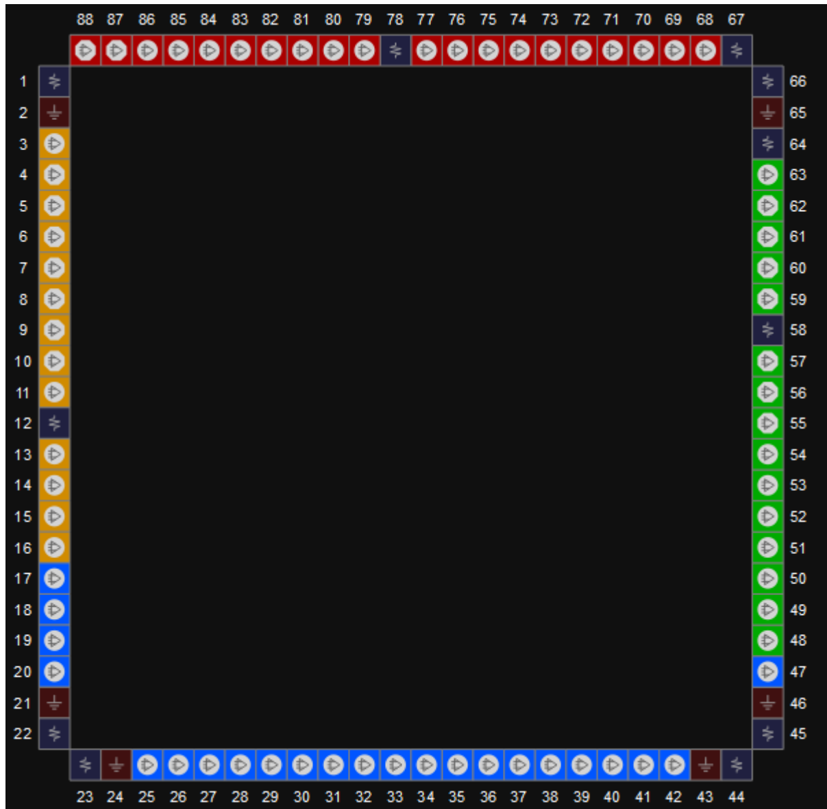
图 3-48 GW1N-4 器件 QN88 封装管脚分布示意图（顶视图）
