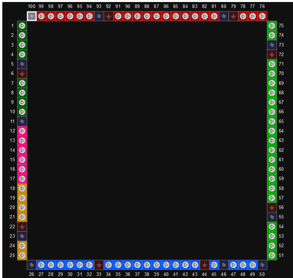
图 3-15 GW1N-2 器件 LQ100 封装管脚分布示意图 (UV 版本,顶视图)
