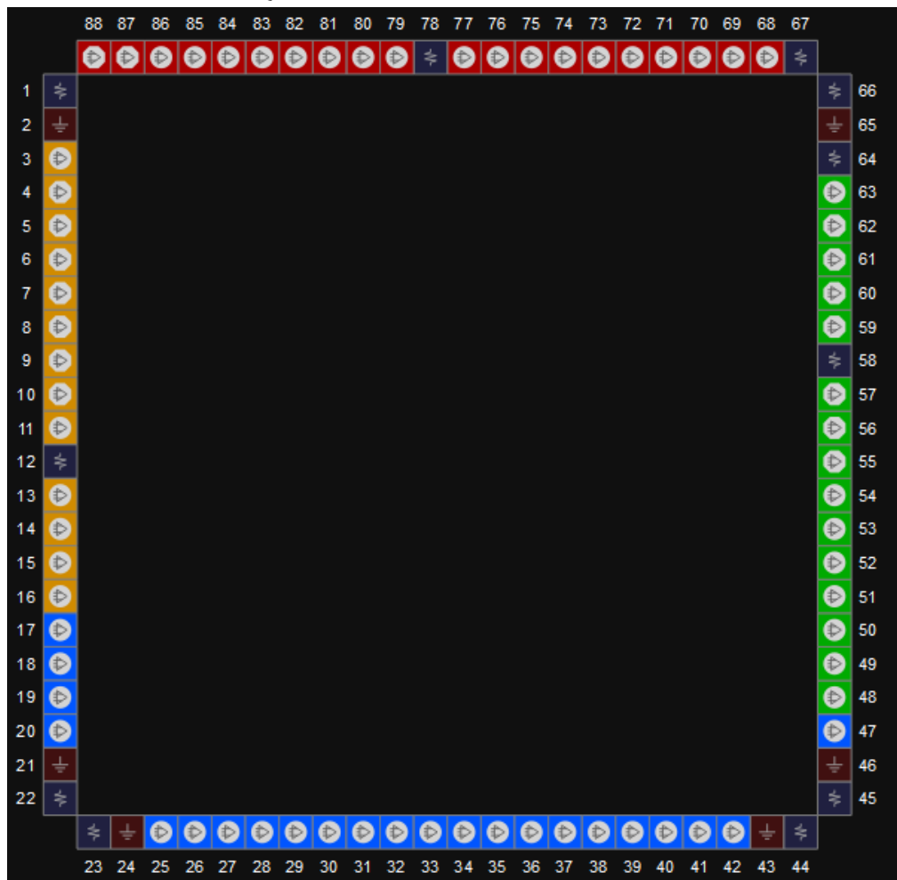
图 3-50 GW1N-4 器件 QN88 封装管脚分布示意图（顶视图）
