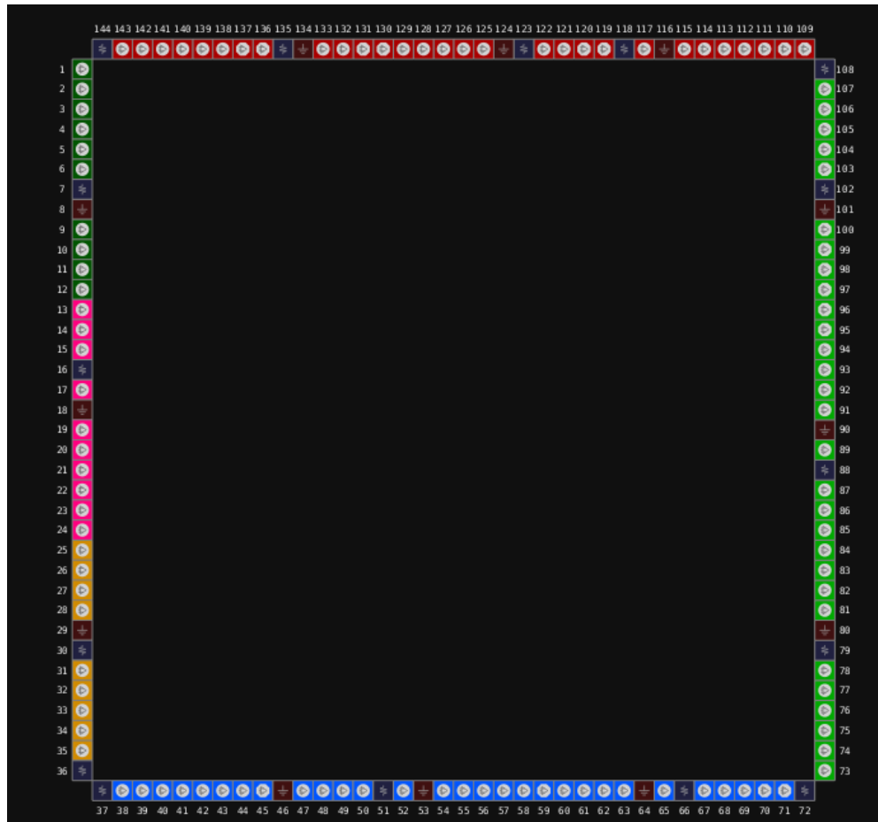
图 3-21 GW1N-2 器件 LQ144F 封装管脚分布示意图 (UV 版本,顶视图)
