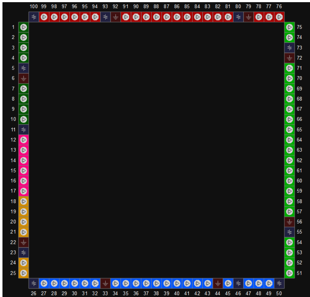
图 3-16 GW1N-2 器件 LQ100 封装管脚分布示意图 (LV 版本,顶视图)
