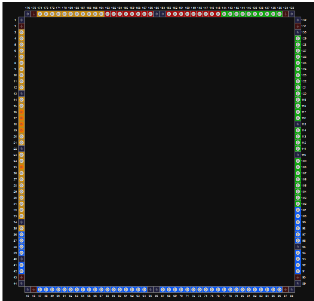
图 3-69 GW1N-9 器件 EQ176 封装管脚分布示意图（顶视图）
