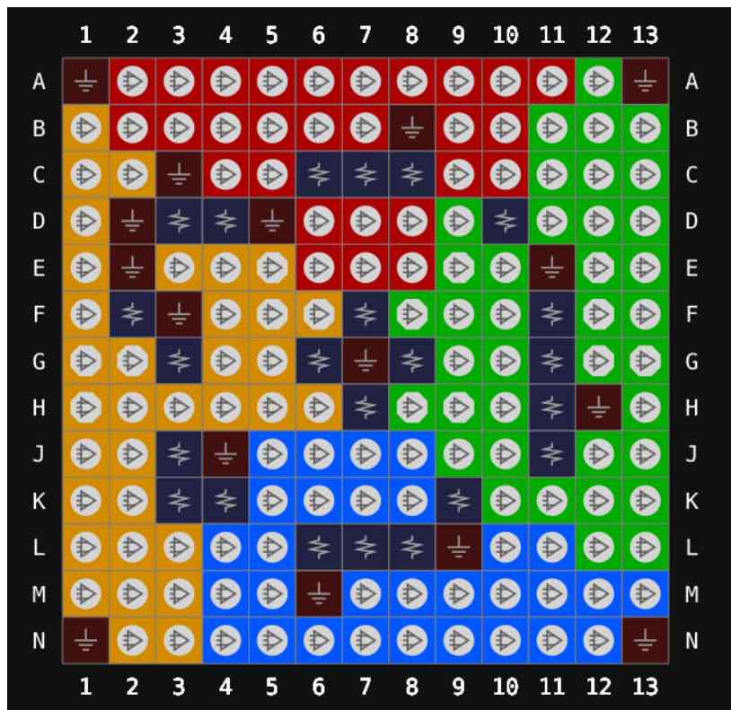
图 3-67 GW1N-9 器件 UG169 封装管脚分布示意图（顶视图）
