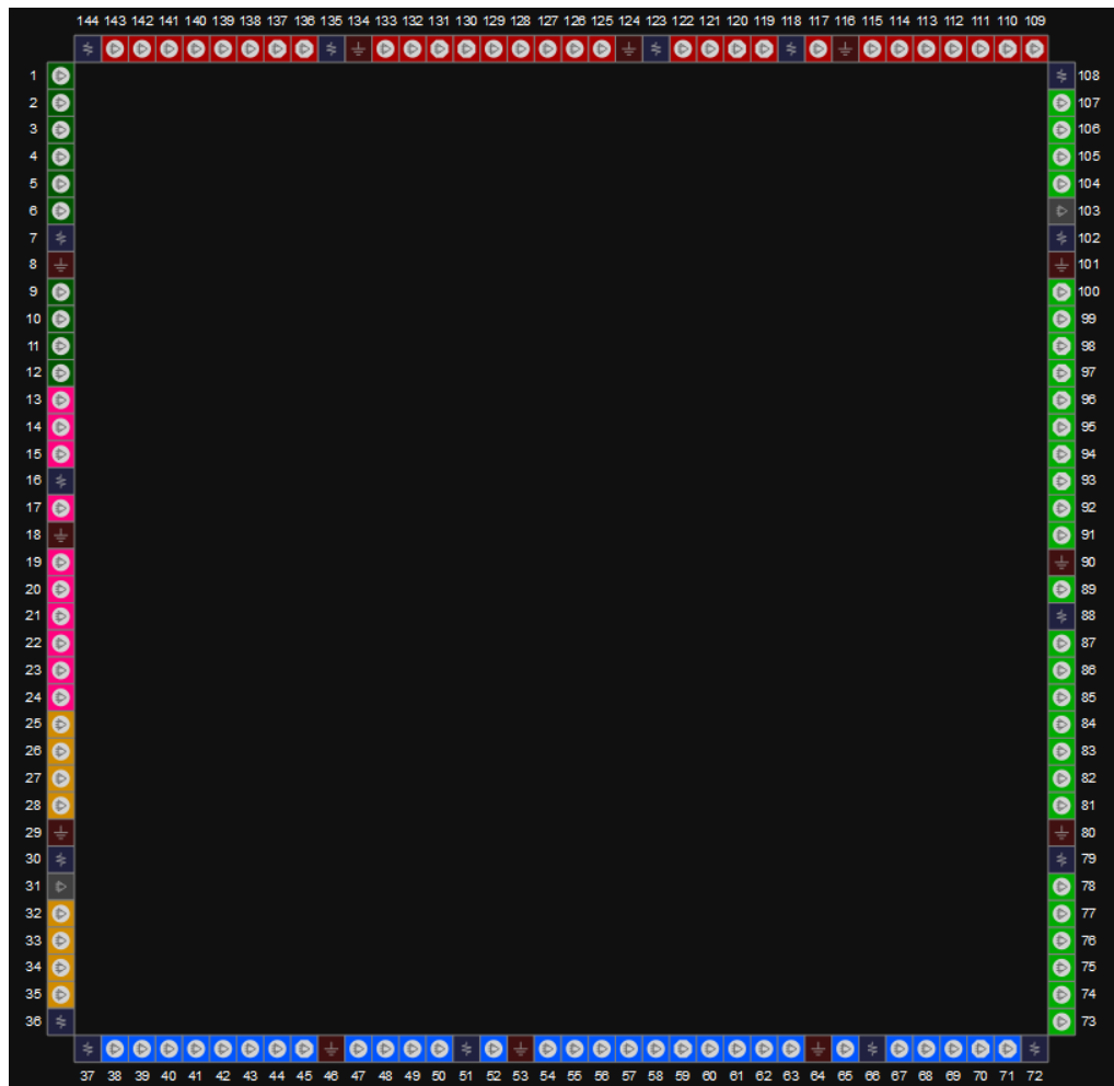
图 3-18 GW1N-2 器件 LQ144X 封装管脚分布示意图 (LV 版本,顶视图)
