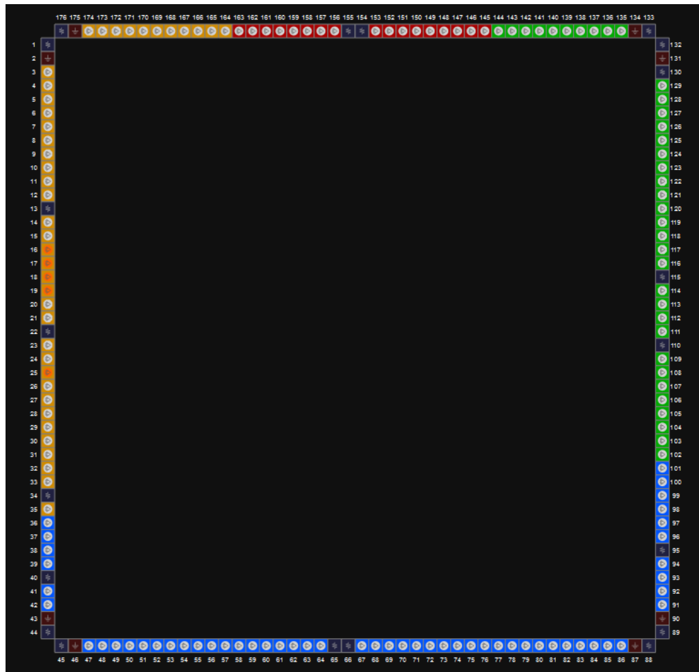
图 3-68 GW1N-9 器件 LQ176 封装管脚分布示意图（顶视图）
