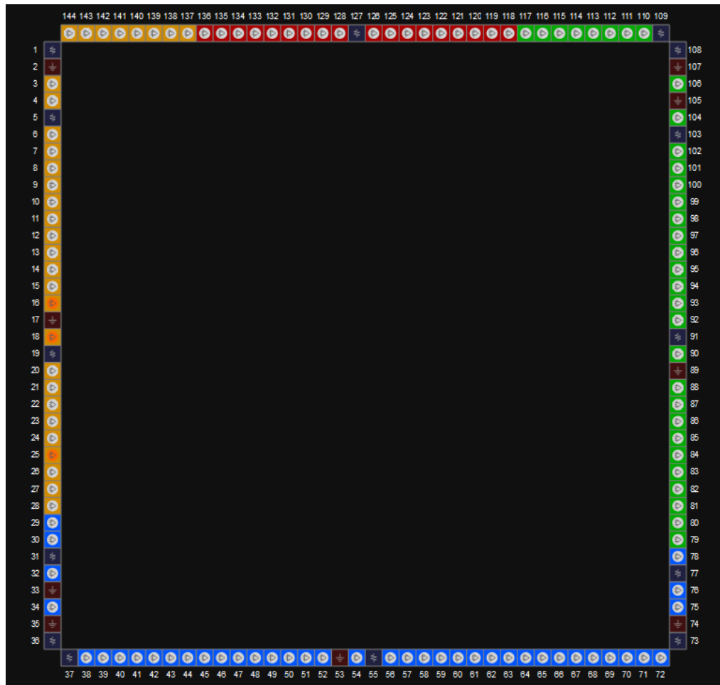
图 3-65 GW1N-9 器件 EQ144 封装管脚分布示意图（顶视图）
