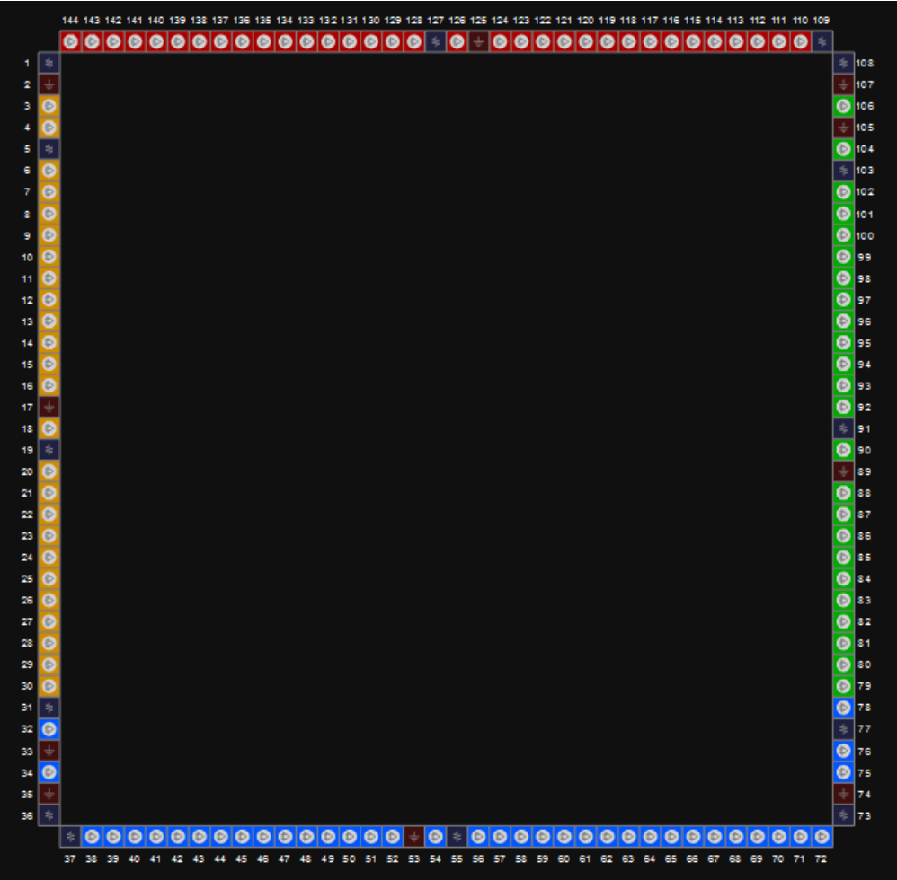
图 3-53 GW1N-4 器件 LQ144 封装管脚分布示意图（顶视图）
