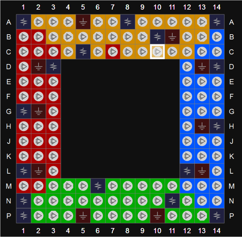
图 3-52 GW1N-4 器件 MG132X 封装管脚分布示意图（顶视图）
