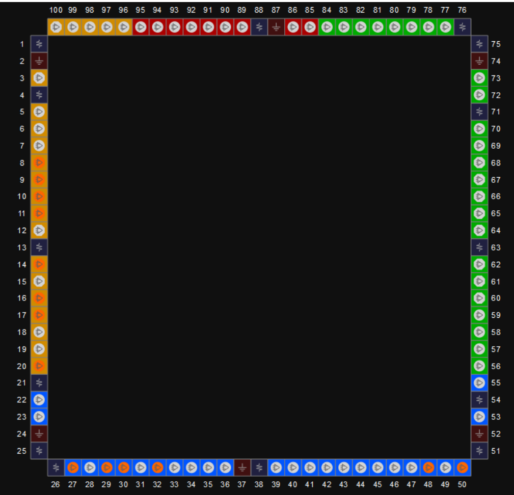
图 3-62 GW1N-9 器件 LQ100 封装管脚分布示意图（顶视图）
