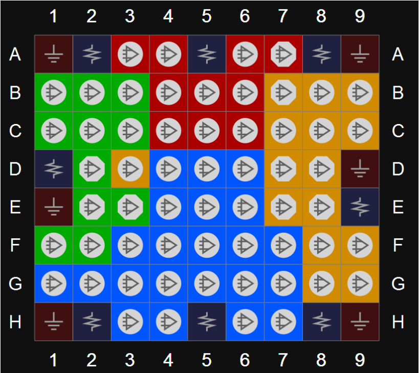
图 3-49 GW1N-4 器件 CS72 封装管脚分布示意图（顶视图）
