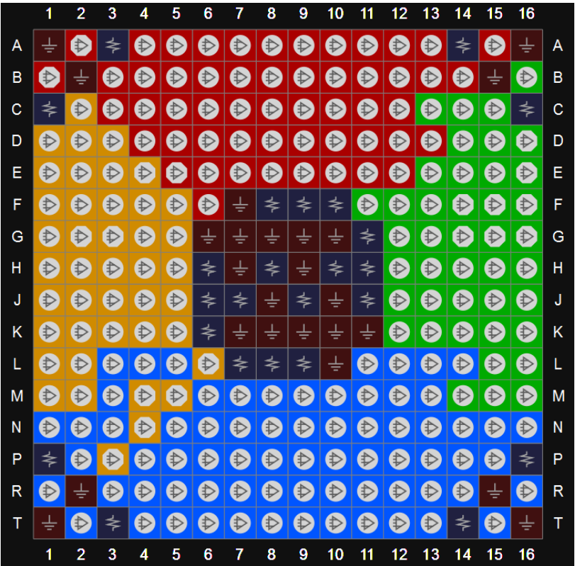
图 3-57 GW1N-4 器件 PG256M 封装管脚分布示意图（顶视图）
