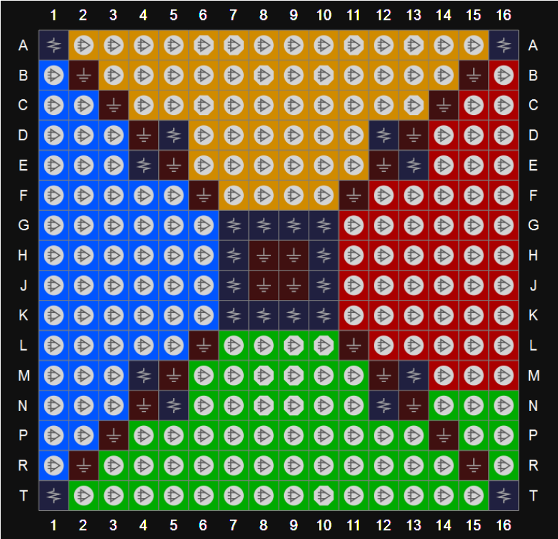
图 3-72 GW1N-9 器件 UG256 封装管脚分布示意图（顶视图）
