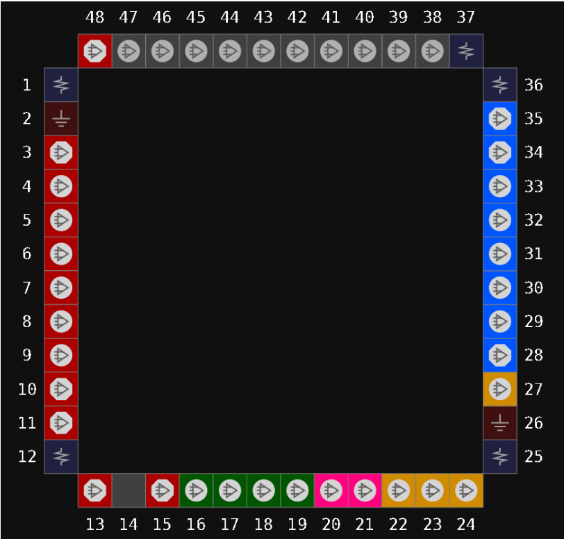
图 3-24 GW1N-2 器件 QN48H 封装管脚分布示意图（顶视图）
