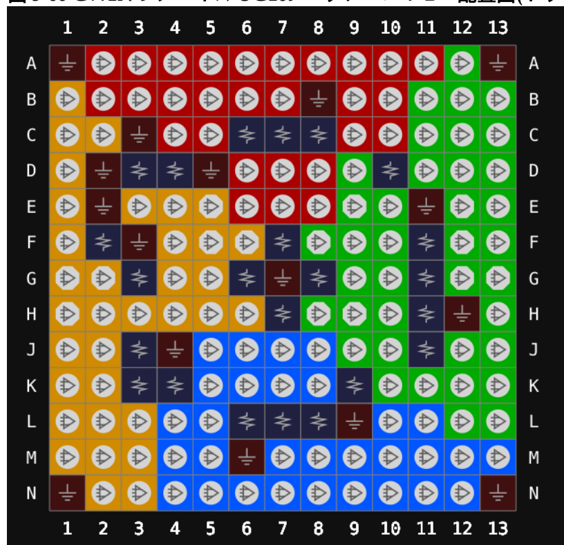
図 3-66 GW1N-9 デバイス UG169 パッケージのピン配置図(トップビュー)
