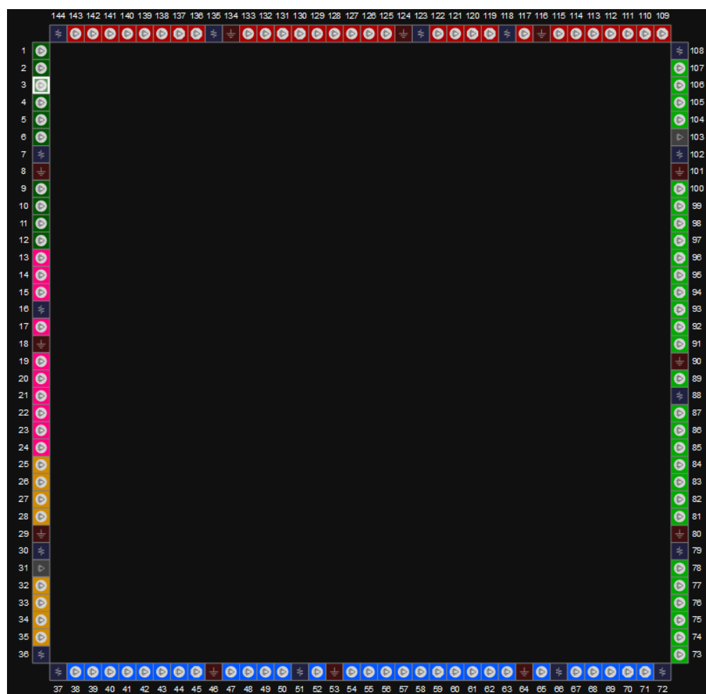
図 3-17 GW1N-2 デバイス LQ144X パッケージのピン配置図(UV バージョン、トップビュー)
