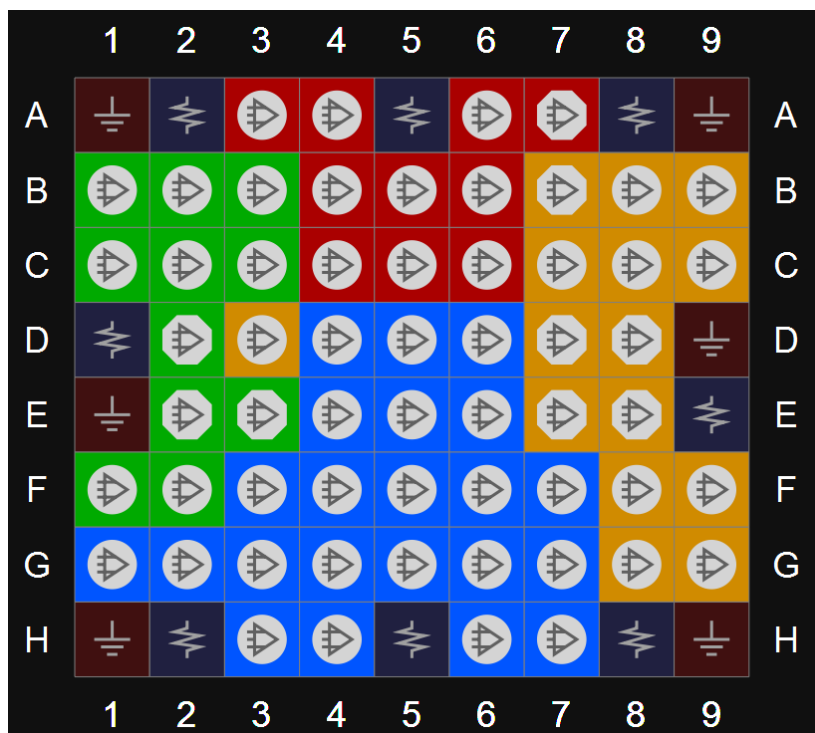
図 3-49 GW1N-4 デバイス CS72 パッケージのピン配置図(トップビュー)
