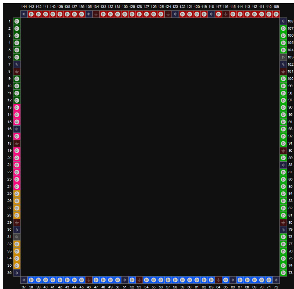
図 3-20 GW1N-2 デバイス LQ144 パッケージのピン配置図(LV バージョン、トップビュー)
