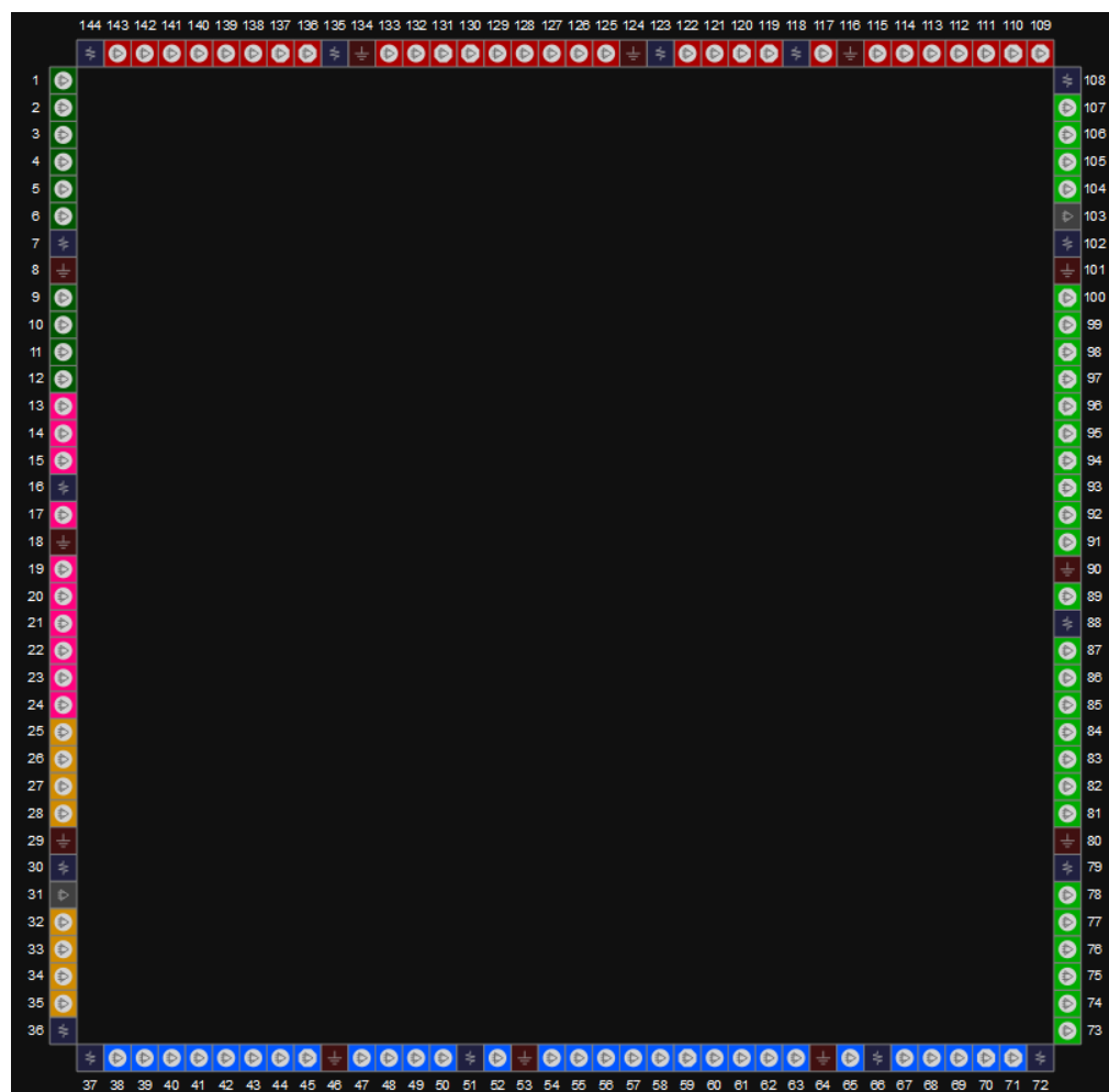
図 3-18 GW1N-2 デバイス LQ144X パッケージのピン配置図(LV バージョン、トップビュー)
