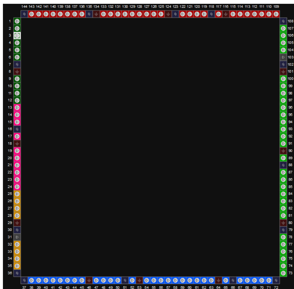
図 3-19 GW1N-2 デバイス LQ144 パッケージのピン配置図(UV バージョン、トップビュー)
