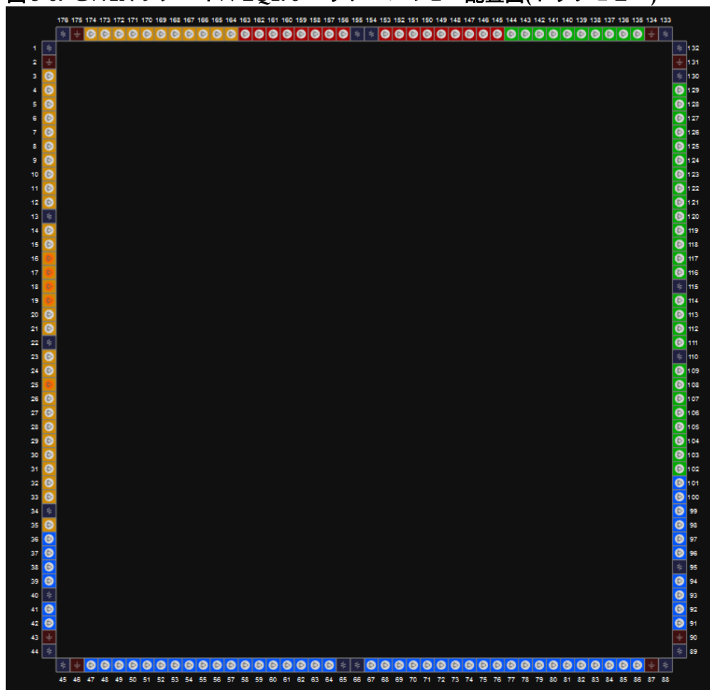
図 3-67 GW1N-9 デバイス LQ176 パッケージのピン配置図(トップビュー)
