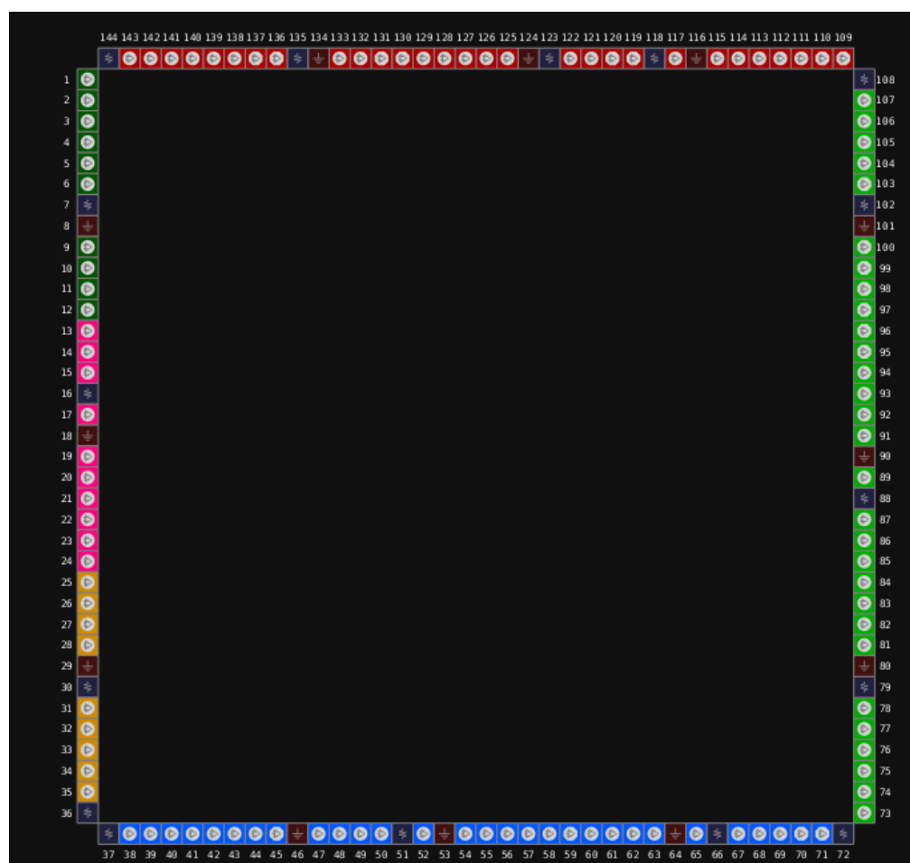
図 3-22 GW1N-2 デバイス LQ144F パッケージのピン配置図(LV バージョン、トップビュー)
