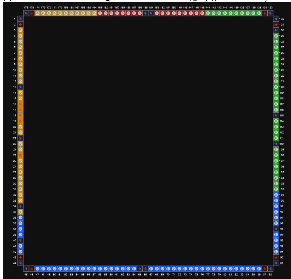
図 3-68 GW1N-9 デバイス EQ176 パッケージのピン配置図(トップビュー)
