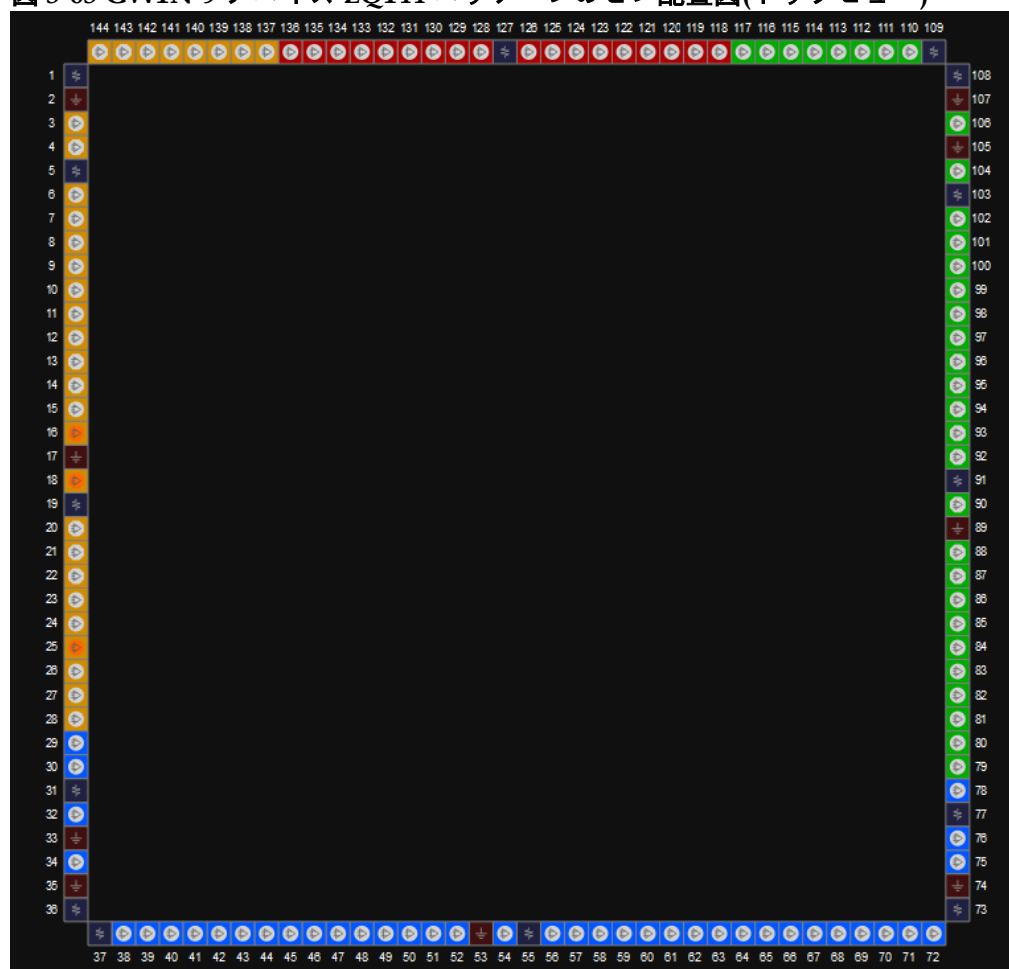
図 3-63 GW1N-9 デバイス LQ144 パッケージのピン配置図(トップビュー)
