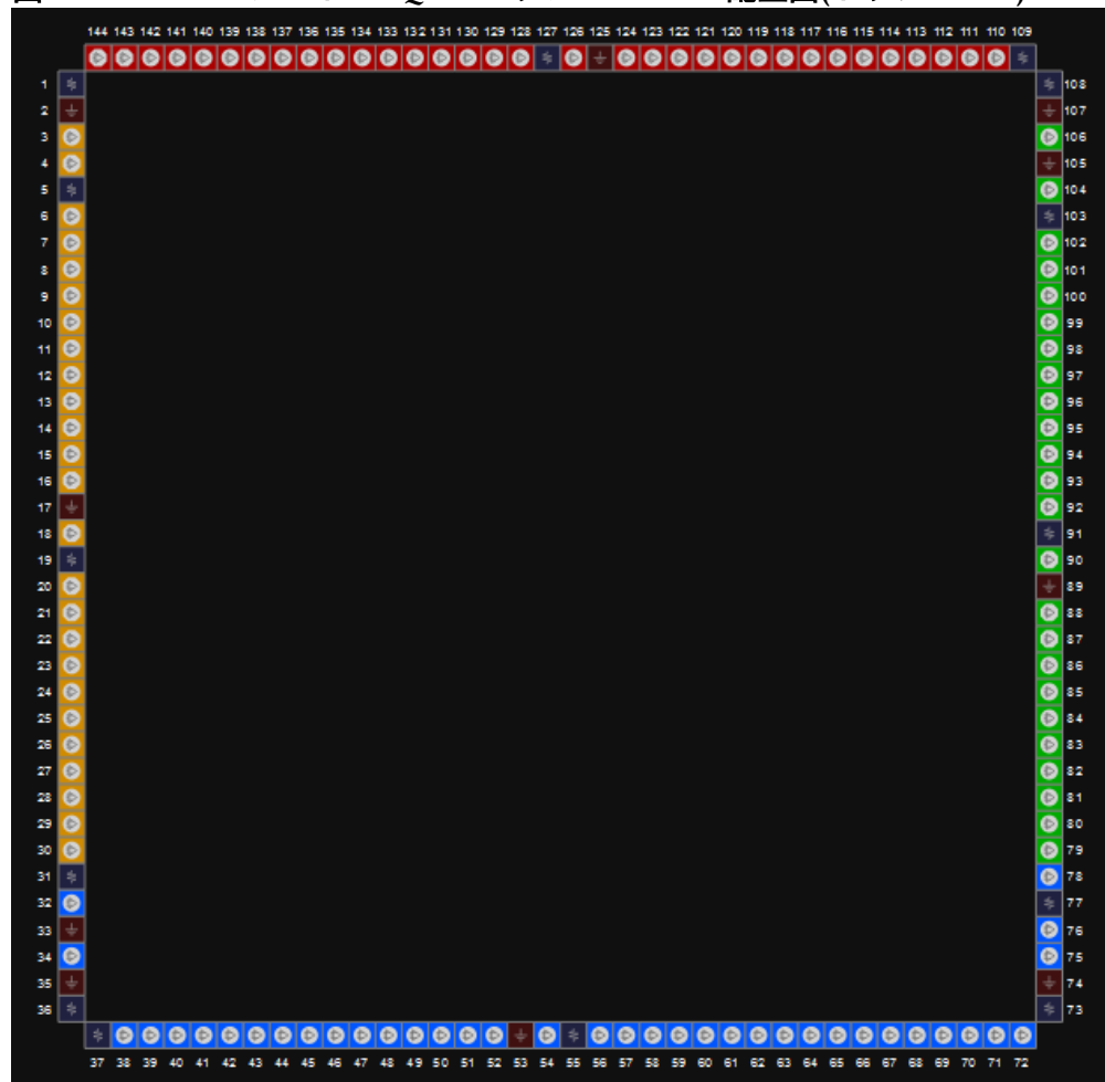
図 3-53 GW1N-4 デバイス LQ144 パッケージのピン配置図(トップビュー)
