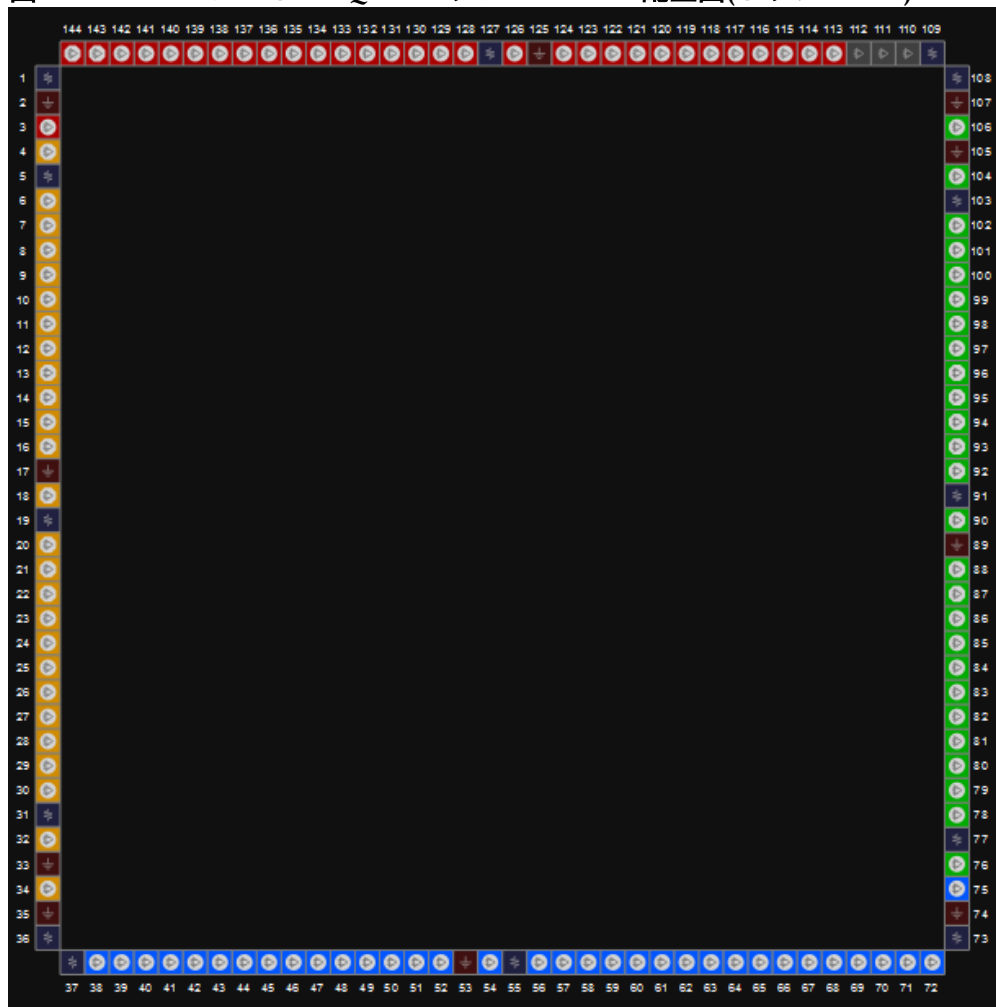
図 3-7 GW1N-1 デバイス LQ144 パッケージのピン配置図(トップビュー)
