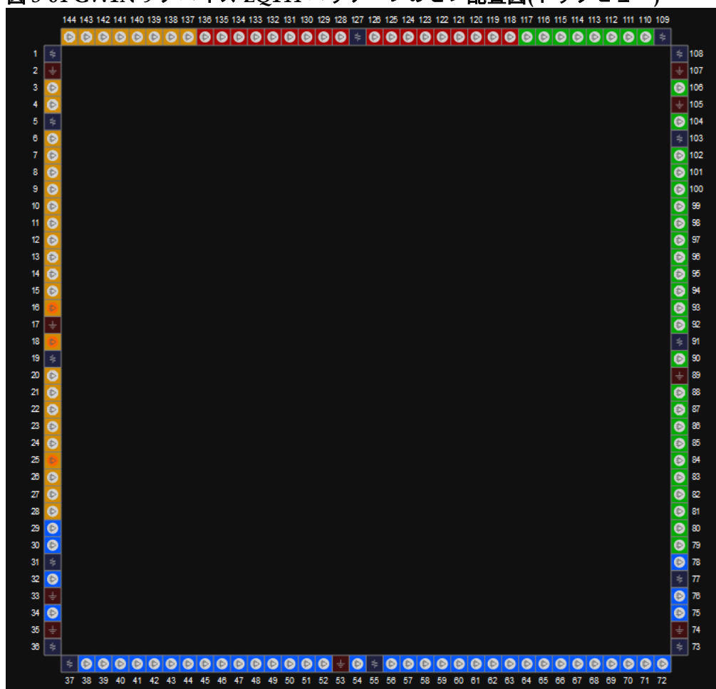
図 3-64 GW1N-9 デバイス EQ144 パッケージのピン配置図(トップビュー)
