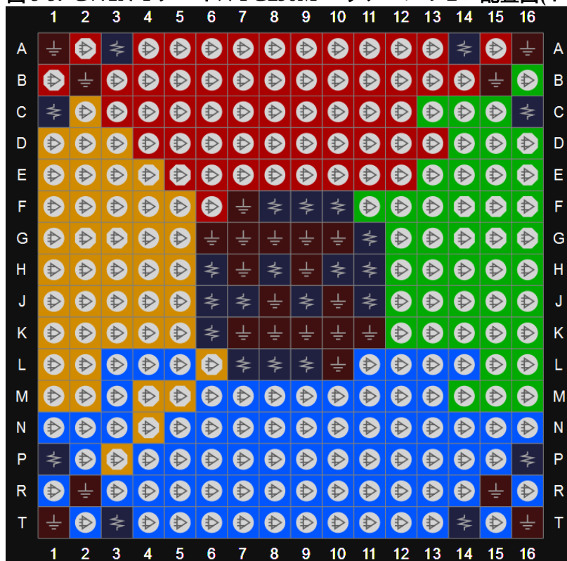
図 3-57 GW1N-4 デバイス PG256M パッケージのピン配置図(トップビュー)
