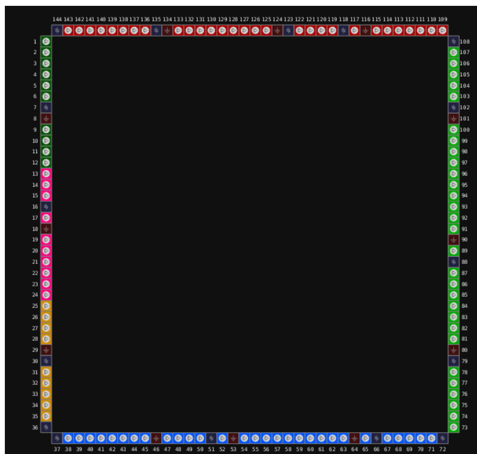
図 3-21 GW1N-2 デバイス LQ144F パッケージのピン配置図(UV バージョン、トップビュー)
