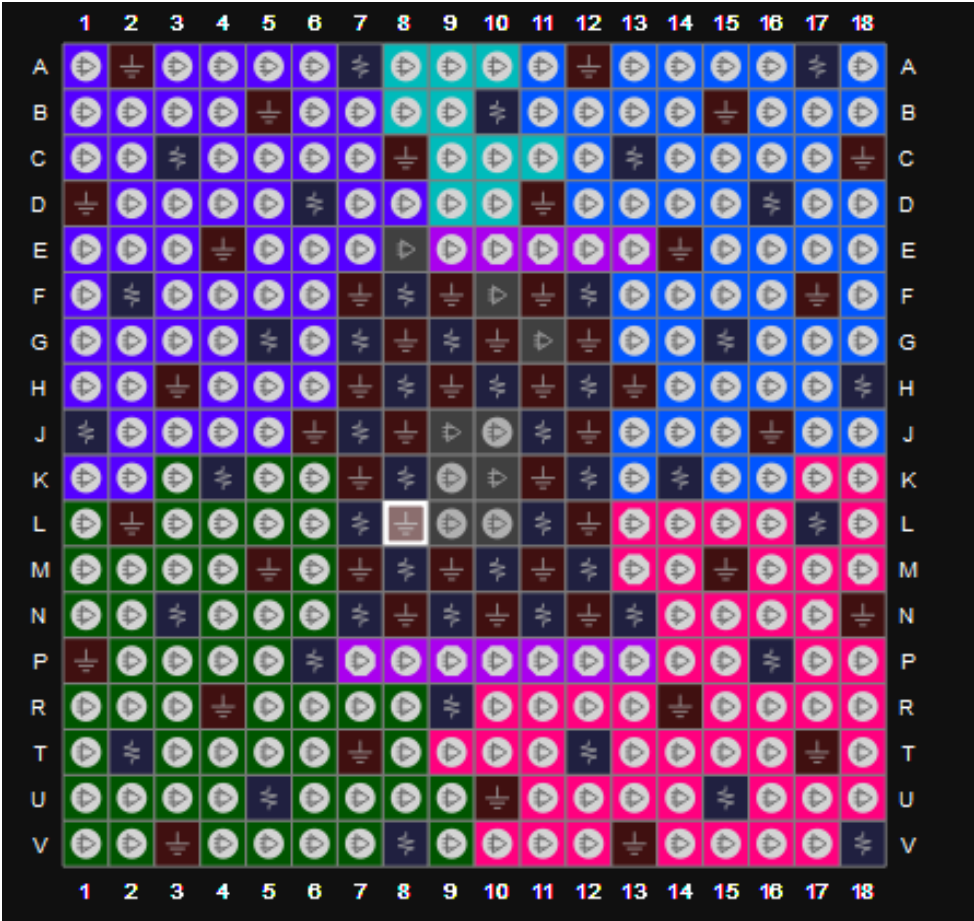
图 3-14 GW5A-138 器件 UG324A 封装管脚分布示意图（顶视图）
