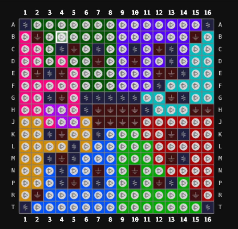
图 3-3 GW5A-25 器件 UG256C EV 版本封装管脚分布示意图（顶视图）
