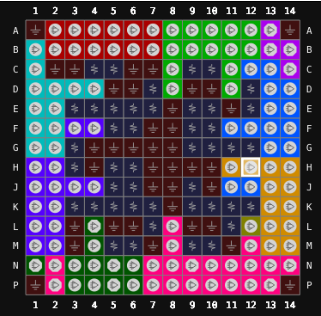
图 3-8 GW5A-25 器件 MG196S EV 版本封装管脚分布示意图（顶视图）
