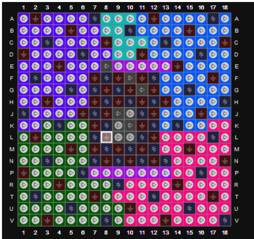
图 3-15 GW5A-138 器件 UG324A 封装管脚分布示意图 (顶视图)
