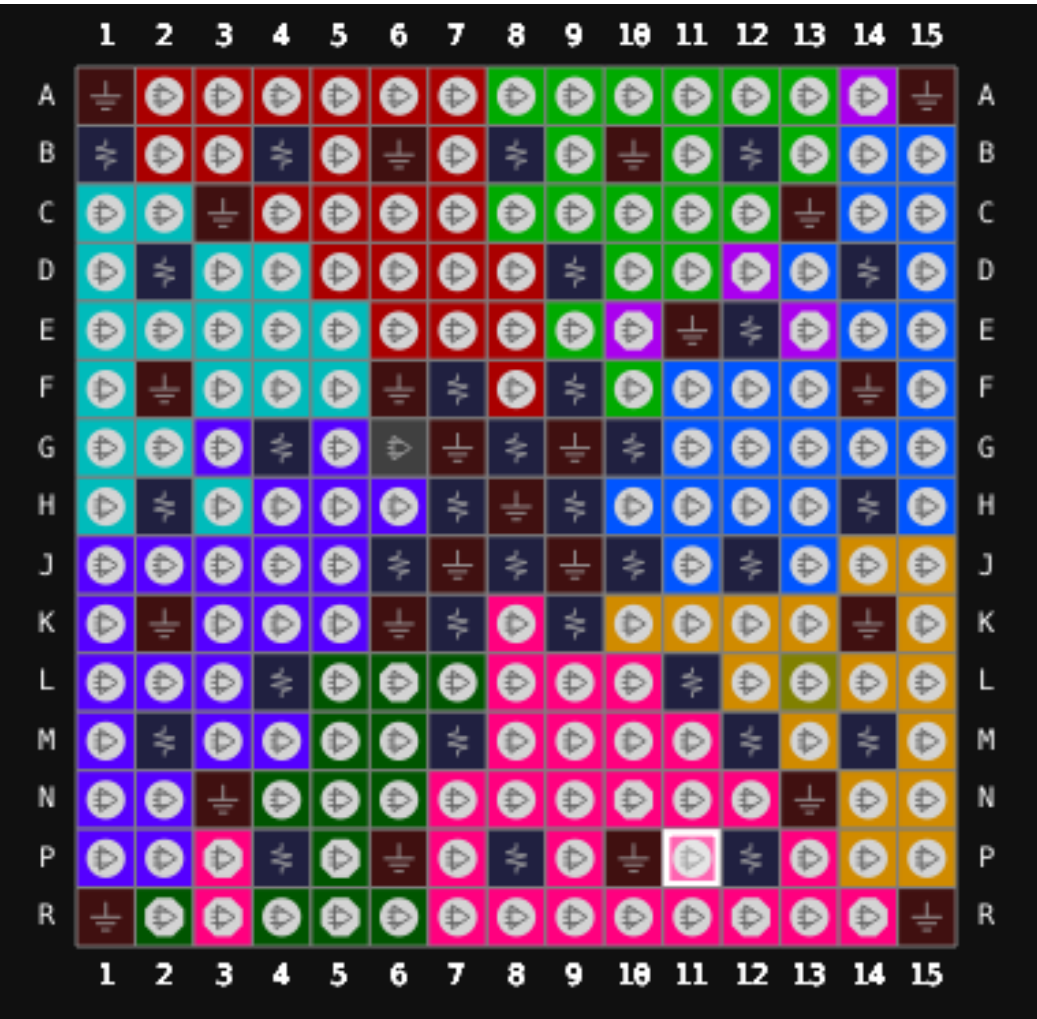
图 3-11 GW5A-25 器件 UG225S LV 版本封装管脚分布示意图（顶视图）
