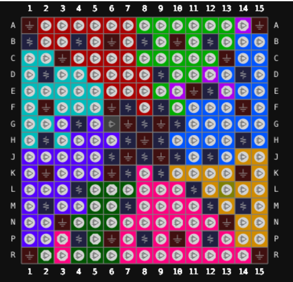
图 3-10 GW5A-25 器件 UG225S EV 版本封装管脚分布示意图（顶视图）
