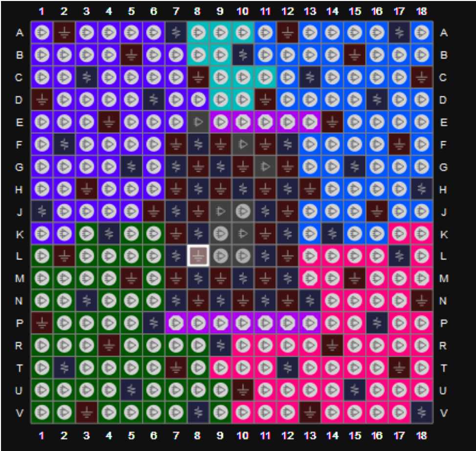
图 3-12 GW5A-138 器件 UG324A 封装管脚分布示意图（顶视图）
