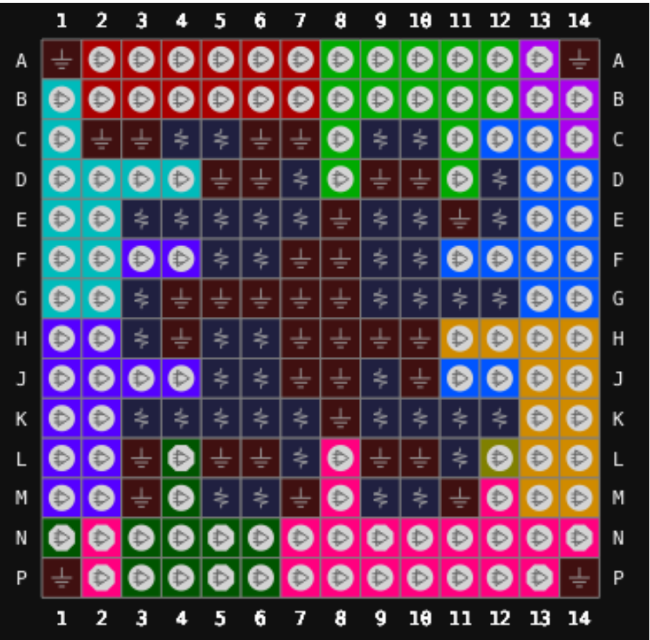
图 3-9 GW5A-25 器件 MG196S LV 版本封装管脚分布示意图（顶视图）
