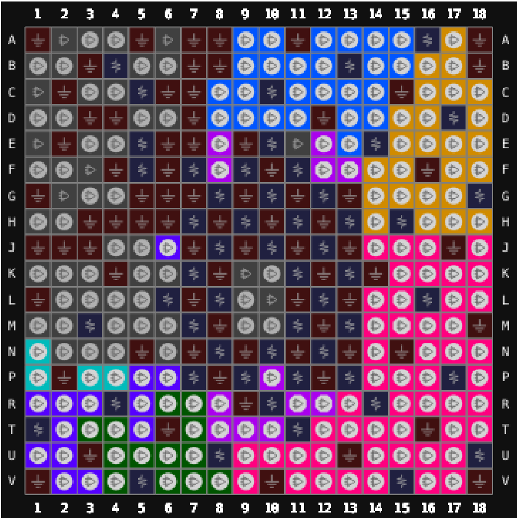
图 3-4 GW5AST-138 器件 UG324 封装管脚分布示意图（顶视图）
