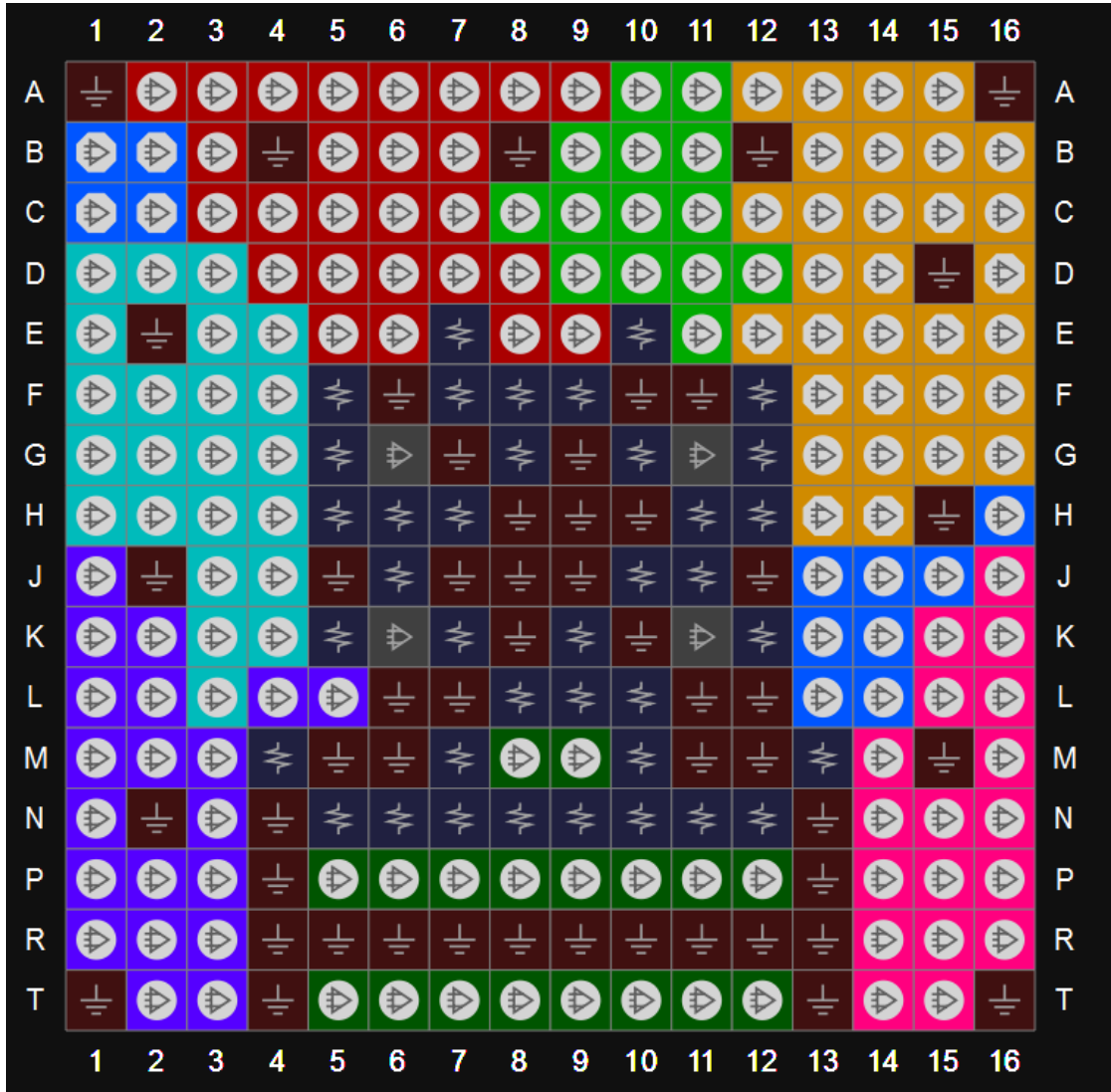
图 3-10 GW2A-18 器件 PG256E 封装管脚分布示意图
