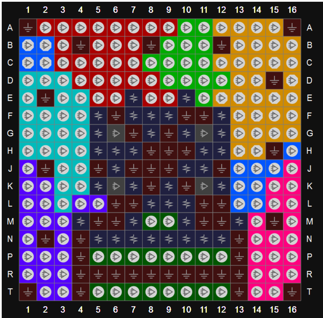
图 3-10 GW2A-18/GW2A-18C 器件 PG256E 封装管脚分布示意图
