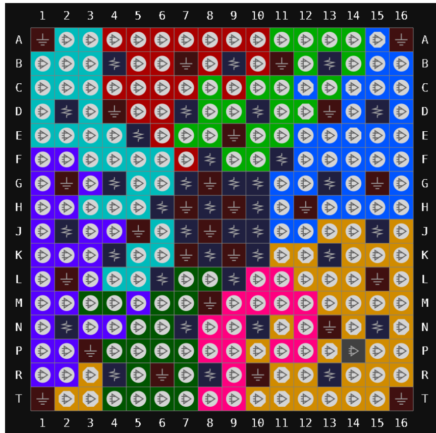
图 3-6 GW2A-18 器件 PG256S 封装管脚分布示意图
