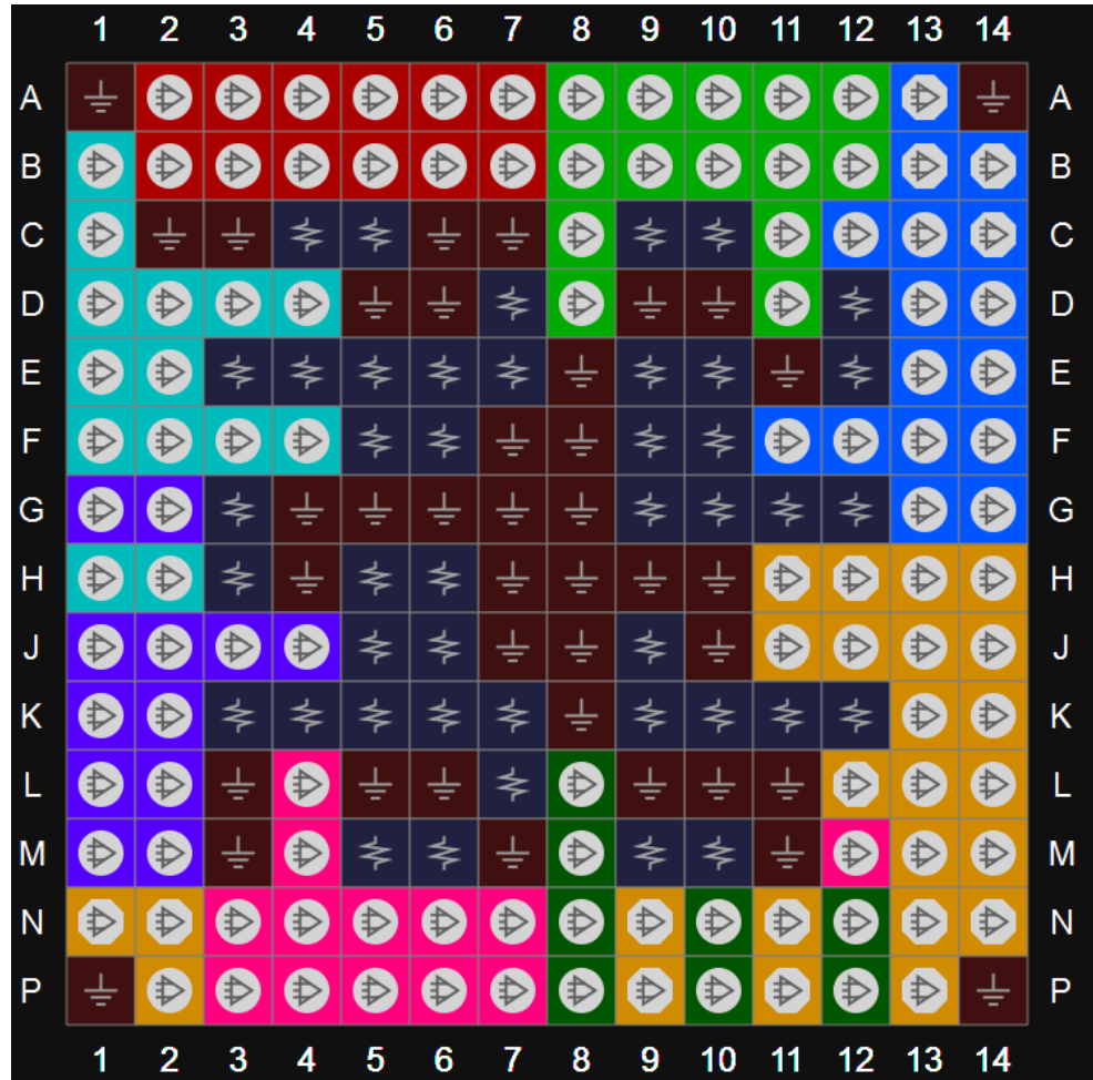
图 3-4 GW2A-18 器件 MG196 封装管脚分布示意图
