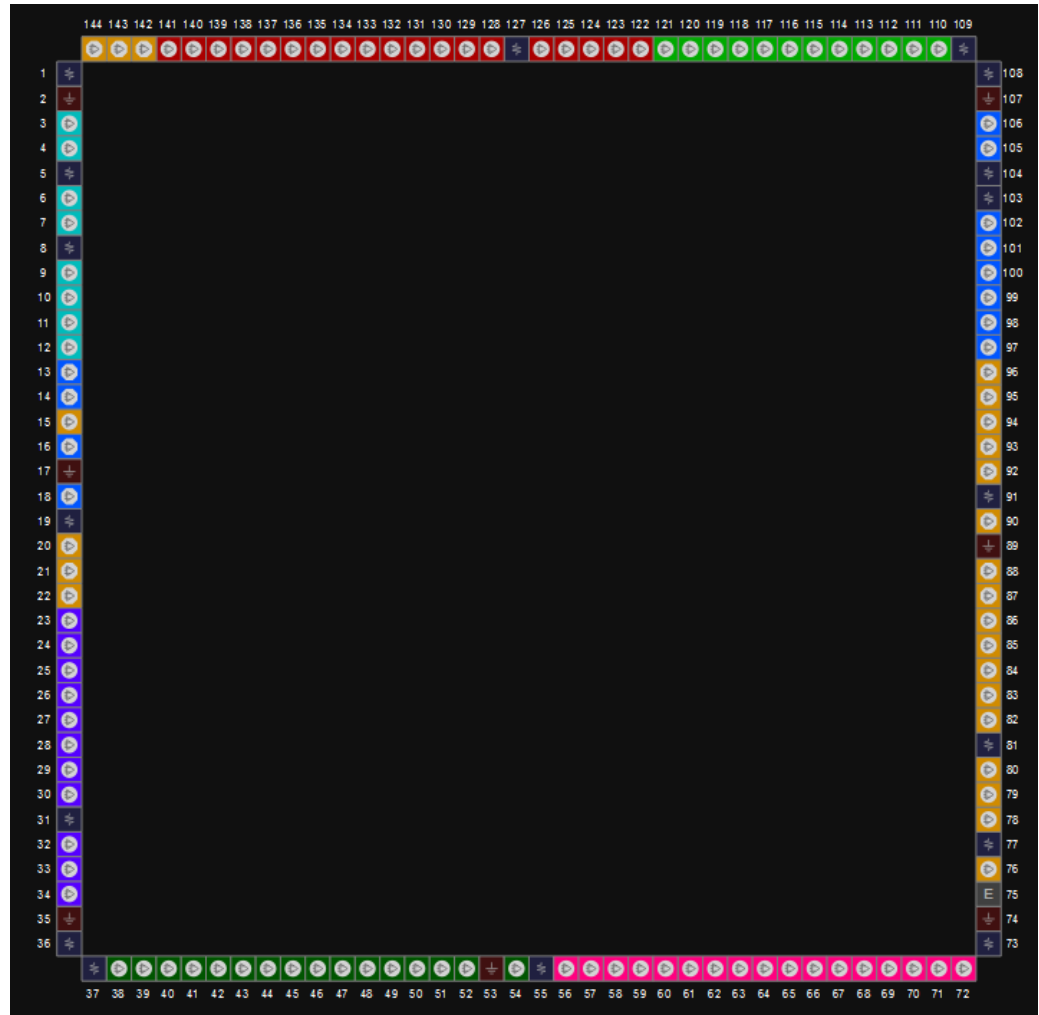
图 3-2 GW2A-18 器件 LQ144 封装管脚分布示意图
