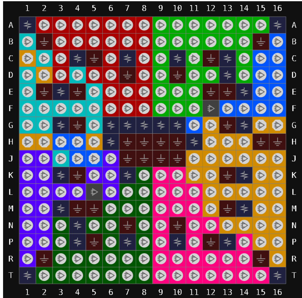
图 3-7 GW2A-18 器件 PG256C 封装管脚分布示意图
