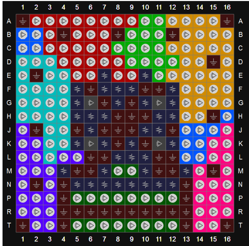
图 3-11 GW2A-18 器件 PG256E 封装管脚分布示意图
