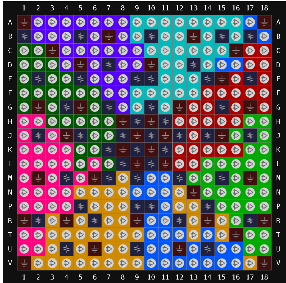
图 3-21 GW2A-55 器件 UG324F 封装管脚分布示意图
