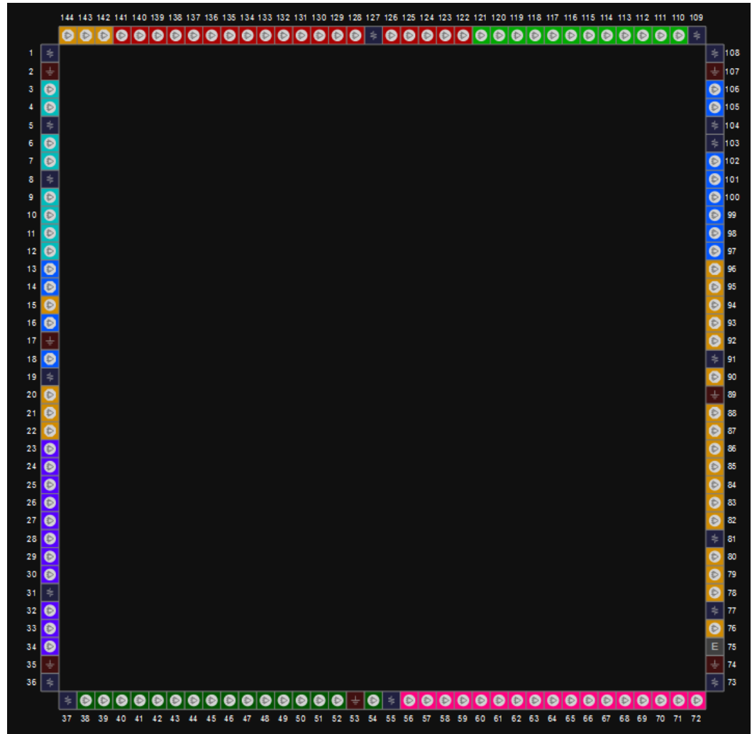
图 3-3 GW2A-18 器件 EQ144 封装管脚分布示意图
