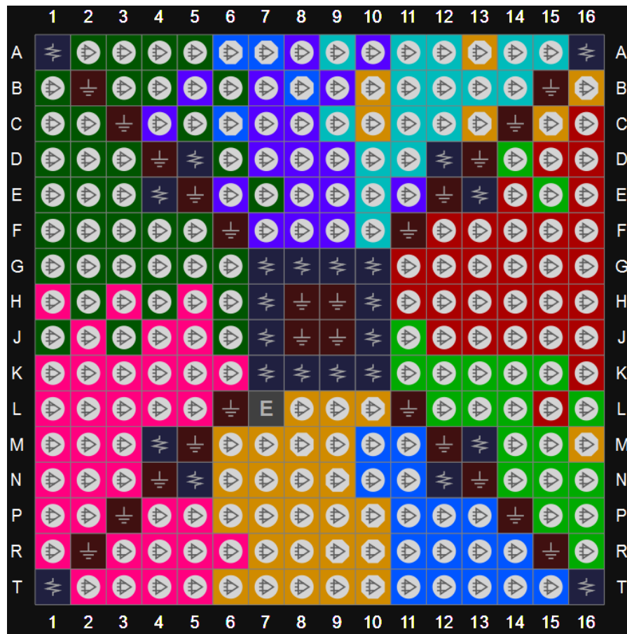
图 3-5 GW2A-18 器件 PG256 封装管脚分布示意图
