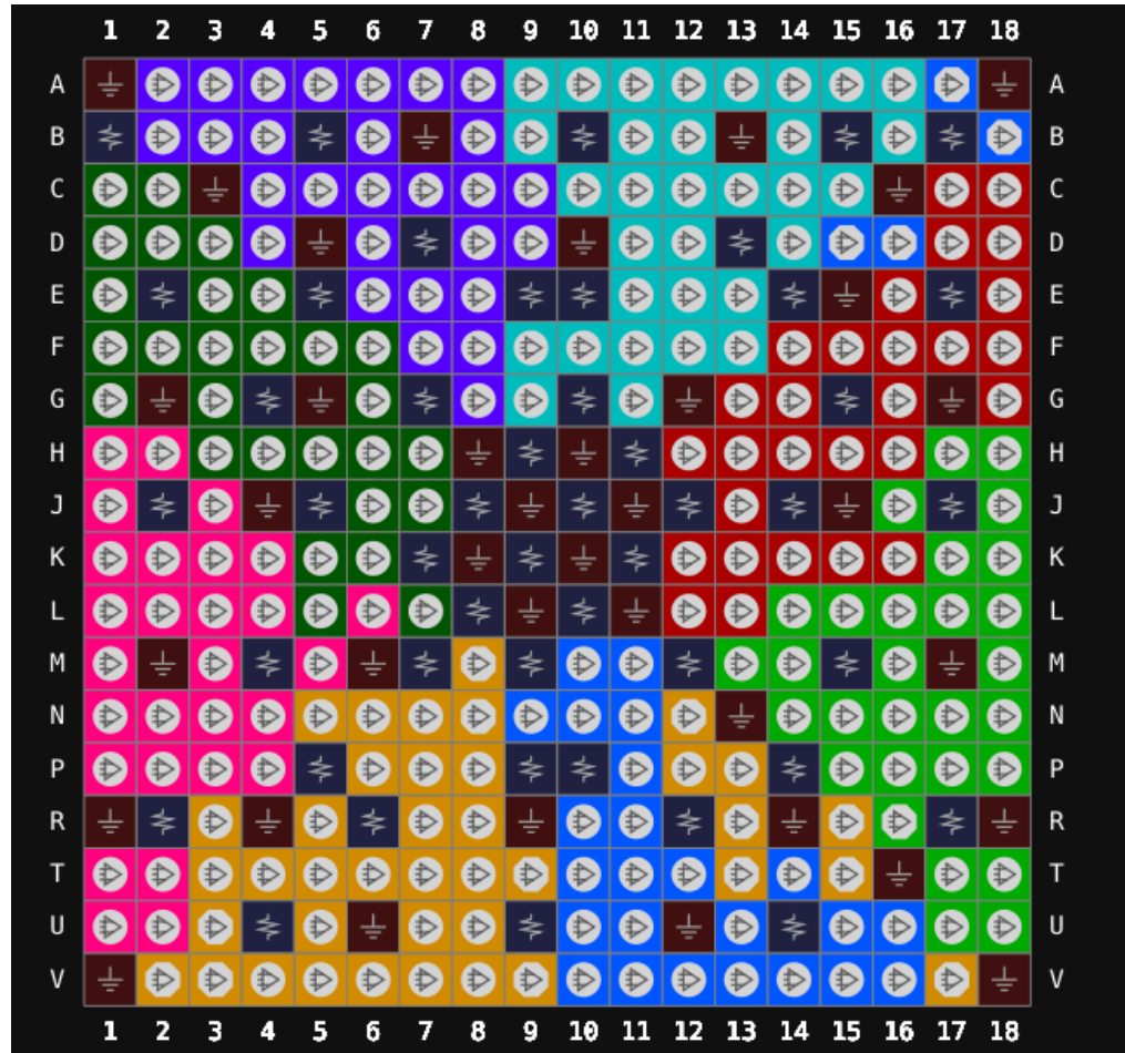
图 3-15 GW2A-55 器件 UG324 封装管脚分布示意图
