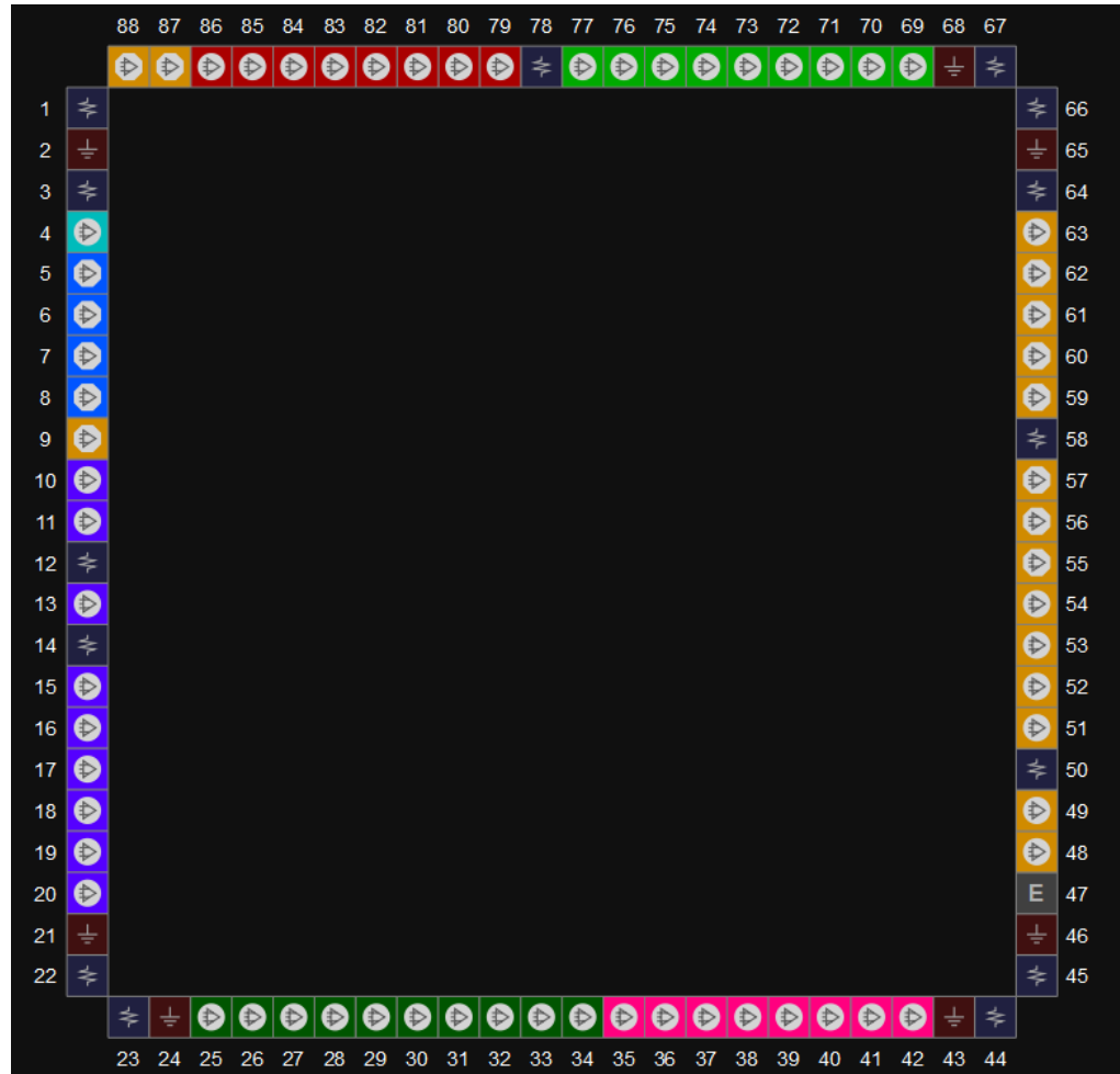
图 3-1 GW2A-18 器件 QN88 封装管脚分布示意图
