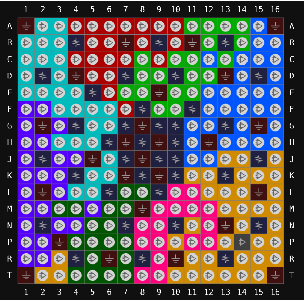
图 3-5 GW2A-18 器件 PG256S 封装管脚分布示意图
