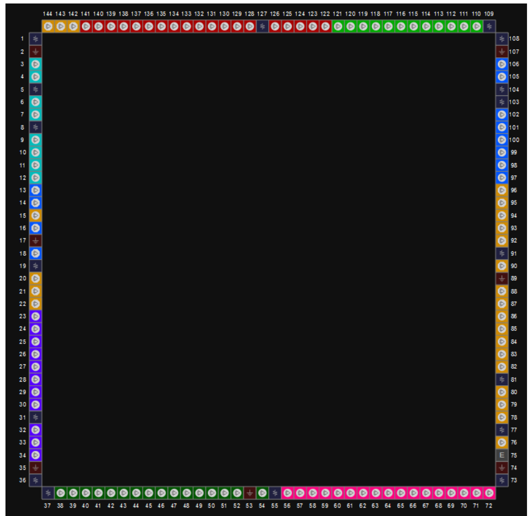
图 3-2 GW2A-18 器件 EQ144 封装管脚分布示意图
