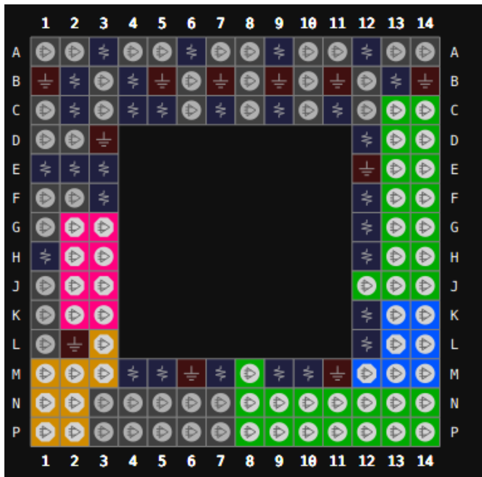
图 3-1 GW5AT-15 器件 MG132 封装管脚分布示意图（顶视图）
