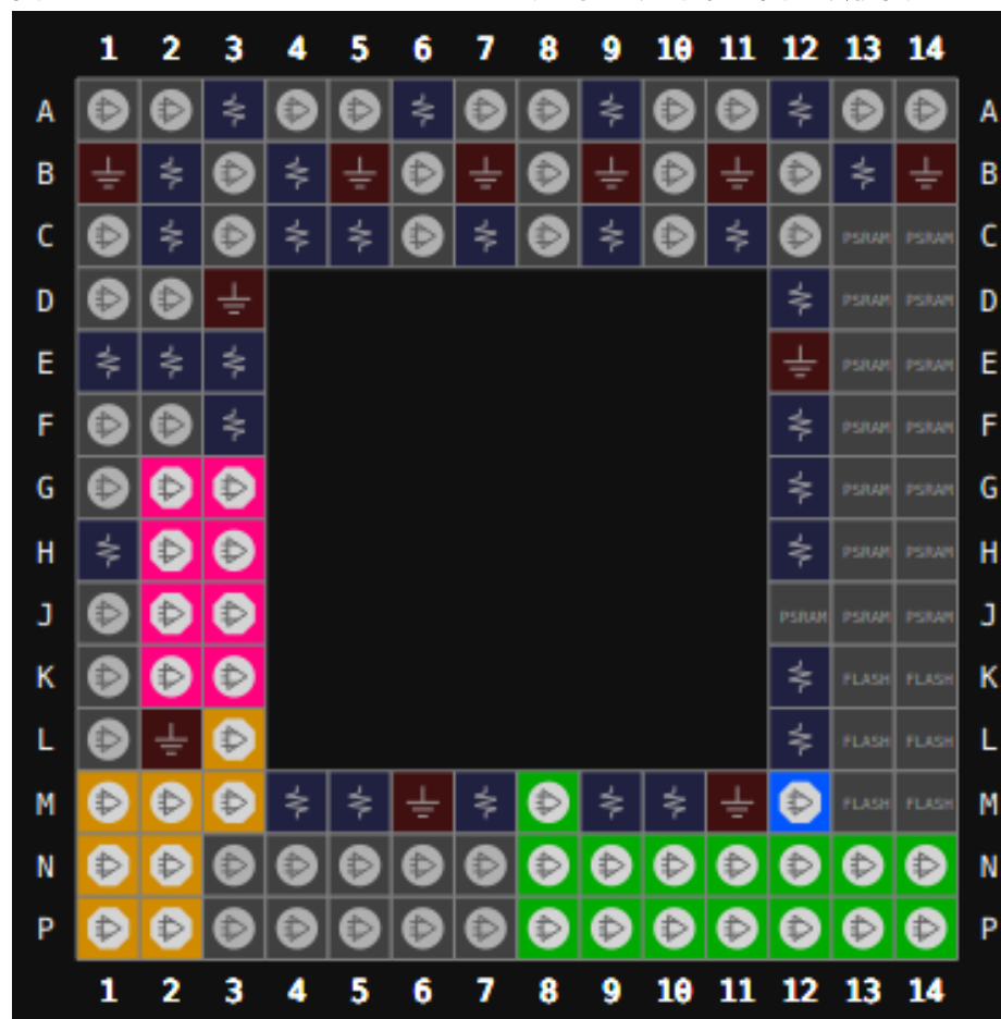
图 3-6 GW5ANRT-15 器件 MG132P 封装管脚分布示意图（顶视图）
